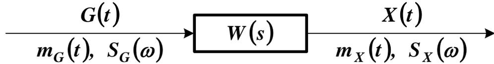
Рисунок 2.3 – Линейная система с передаточной функцией  $W(s)$ , находящаяся под влиянием случайного воздействия
