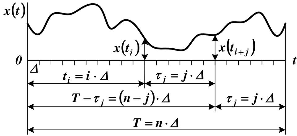
Рисунок 1.8 – Определение корреляционной функции по экспериментальным данным
