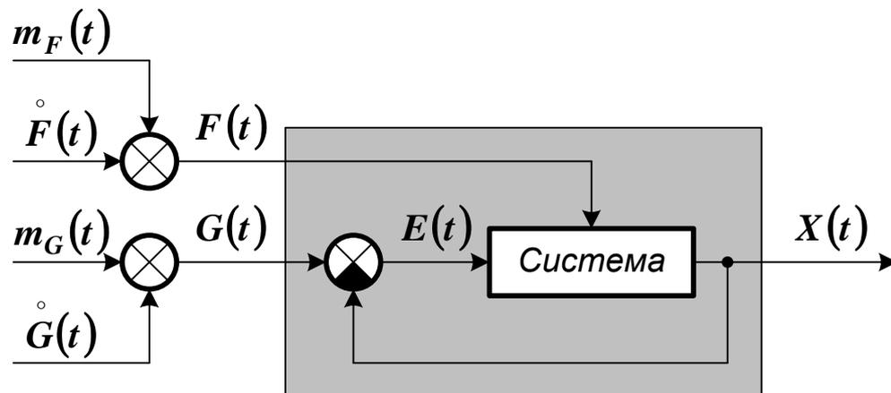
Рисунок 2.6 – Система, находящаяся под влиянием двух случайных воздействий
