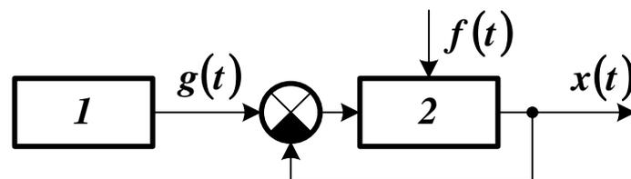
С помощью задатчика 1 устанавливается нужное значение курса  $g(t)$ . На летательный аппарат 2 действует возмущение атмосферы  $f(t)$ . Задача стабилизации заключается в поддержании действительного курса, равным заданному.
