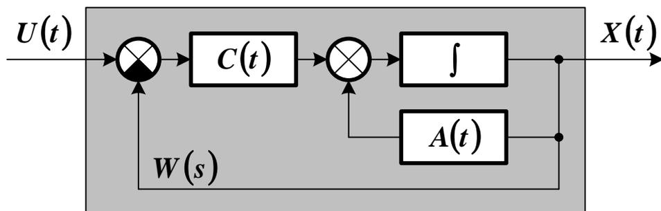
Рисунок 3.8 – Структурная схема оптимального фильтра
