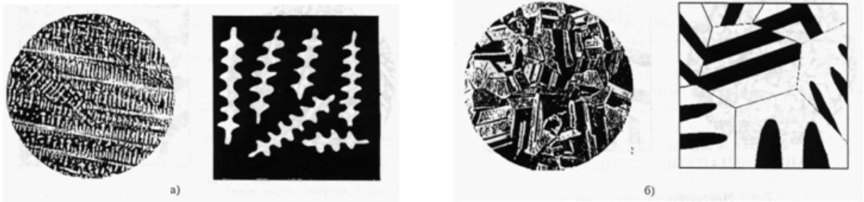
Рис. 3. Микроструктура однофазной латуни (справа - схематическое изображение): а) литой; б) деформированной и отожженной
