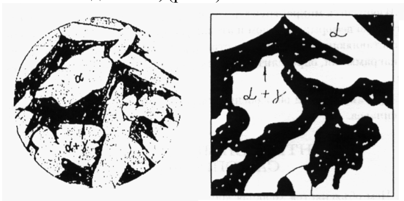
Рис. 5. Микроструктура литой двухфазной бронзы (справа - схематическое изображение)
