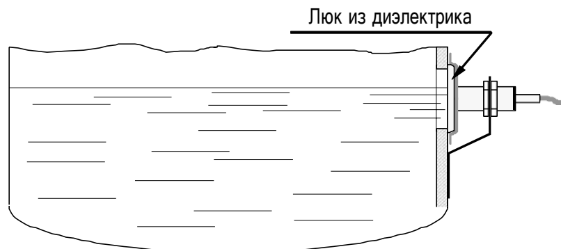
Рисунок 7 – Пример монтажа выключателей для контроля уровня жидкости
