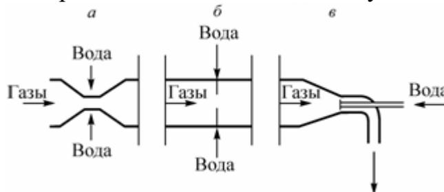
**Рис. 1.14.** Схемы скоростных газопромывателей: а) Вентури; б) диафрагменный; в) с подвижным дисковым шибером
