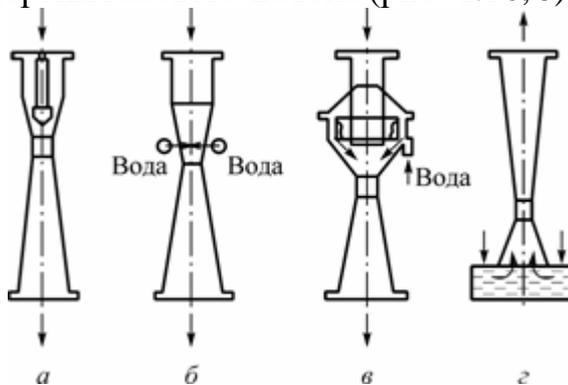
**Рис. 1.16.** Способы подачи жидкости в трубу Вентури: *а*) центральный (форсуночный) подвод жидкости; *б*) периферийное орошение; *в*) пленочное орошение; *г*) бесфорсуночное орошение
