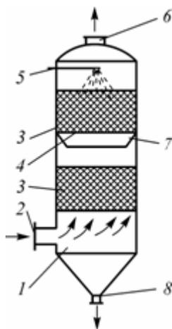
**Рис. 1.2.** Схема противоточного насадочного скруббера: 1 – корпус скруббера; 2 – входной патрубок; 3 – насадка; 4 – решетка для насадки; 5 – трубопровод для подачи жидкости; 6 – выходной патрубок; 7 – направляющий конус для жидкости; 8 – штуцер для вывода шлама
