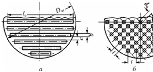
**Рис. 1.5.** Конструкции провальных тарелок: а) щелевая; б) дырчатая
