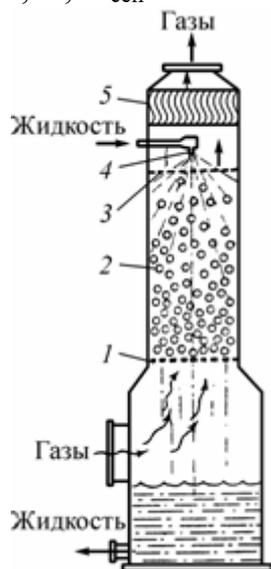
**Рис. 1.7.** Цилиндрический пылеуловитель с подвижной шаровой насадкой: 1 – опорная тарелка; 2 – шаровая насадка; 3 – отражательная тарелка; 4 – ороситель; 5 – брызгоуловитель
