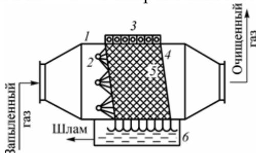
**Рис. 1.3.** Насадочный скруббер с поперечным орошением: 1 – корпус; 2 – форсунки; 3 – оросительное устройство; 4 – опорная решетка; 5 – насадка; 6 – шламосборник
