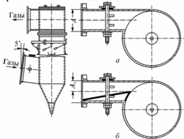
**Рис. 1.12.** Циклон с водяной пленкой (ЦВП): а) основное исполнение; б) вариант с повышенной скоростью воздуха на входе в циклон
