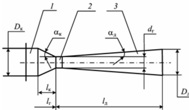
**Рис. 1.15.** Конфигурация трубы Вентури: 1 – конфузор; 2 – горловина; 3 – диффузор
