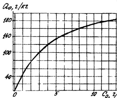
Рис. 2.1. Изотерма паров этилового спирта на активированном угле при 20°C
