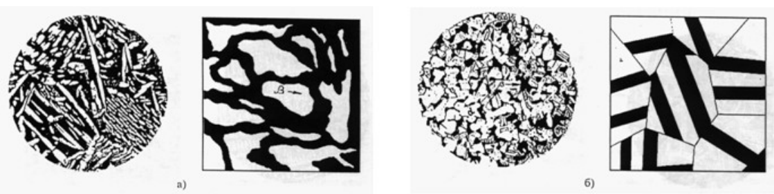
Рис. 4. Микроструктура двухфазной латуни (справа - схематическое изображение): а) литой; б) после деформации и отжига
