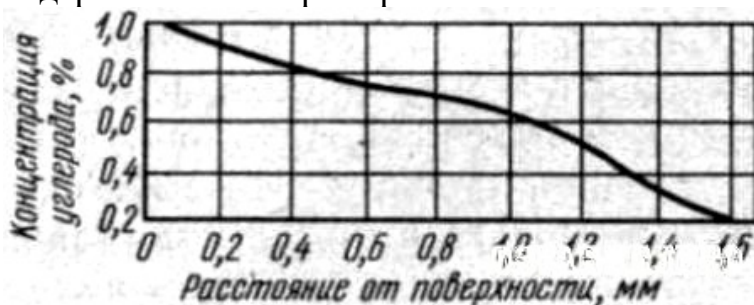
Рис. 1. Изменение концентрации (%) углерода в цементованном поверхностном слое.
