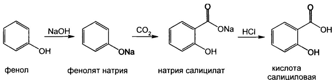
Выпаренную досуха смесь фенола и эквивалентного количества гидроксида натрия нагревают в автоклавах (130°С) с диоксидом углерода под давлением 450-500 кПа (4,5-5 атм). Продукт реакции растворяют в воде, подкисляют хлороводородной кислотой и выделившуюся кислоту салициловую перекристаллизовывают.
