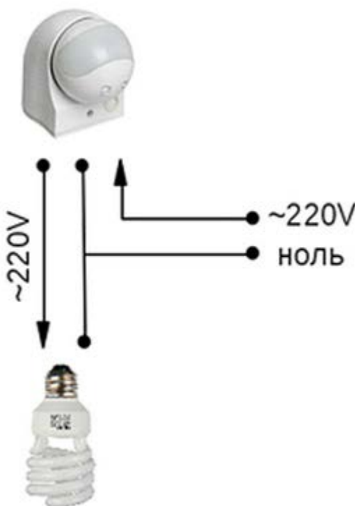
Рисунок 1. Схема подключения датчика движения
