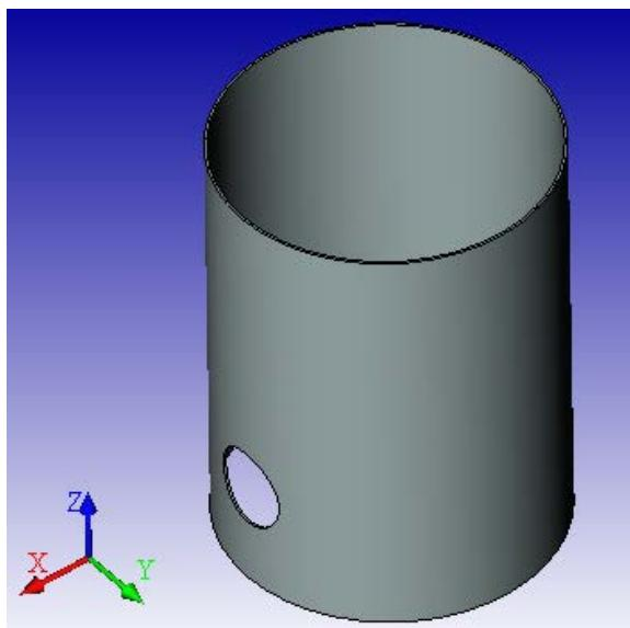
Рисунок 10.2 – 3D–модель обечайки
