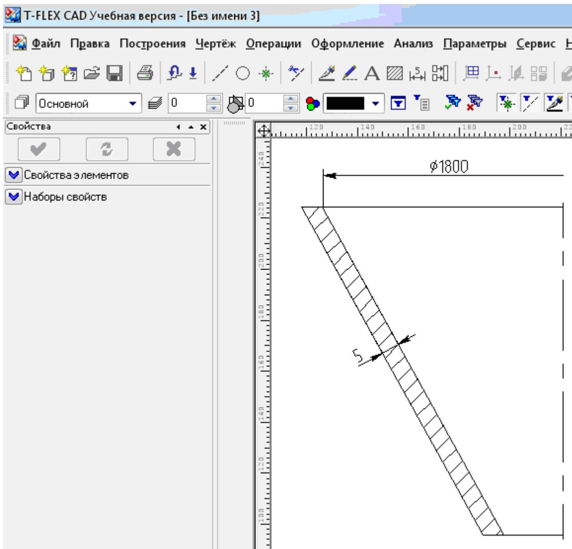
Рисунок 12.11 – Графическая модель конической обечайки (фрагмент окна)
