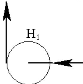
Рисунок 9.6 – Изображение насоса на технологической схеме
