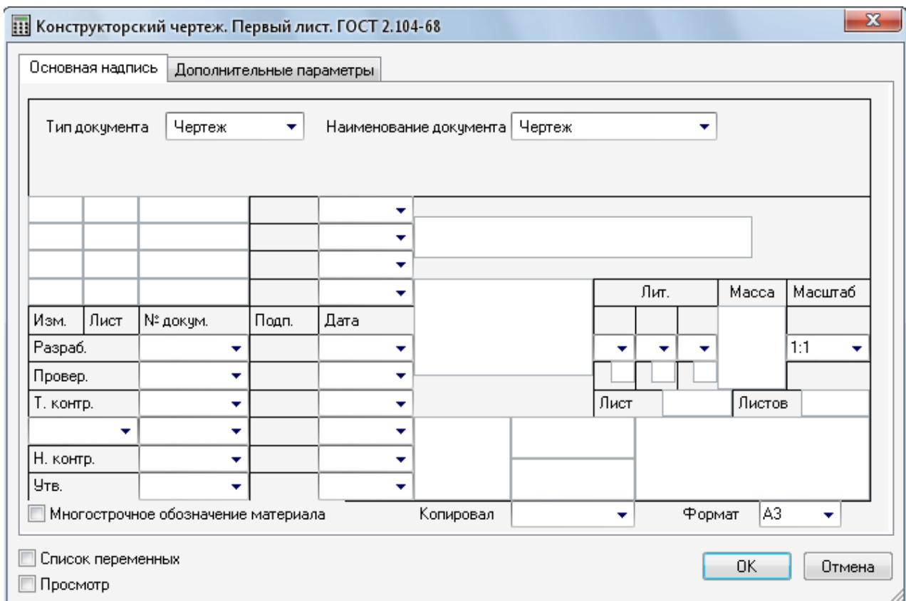
Рисунок 9.11 – Пример заполнения штампа чертежа
