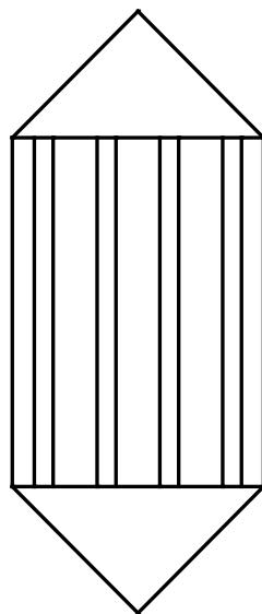
Рисунок 9.5 – Изображение теплообменника на технологической схеме
