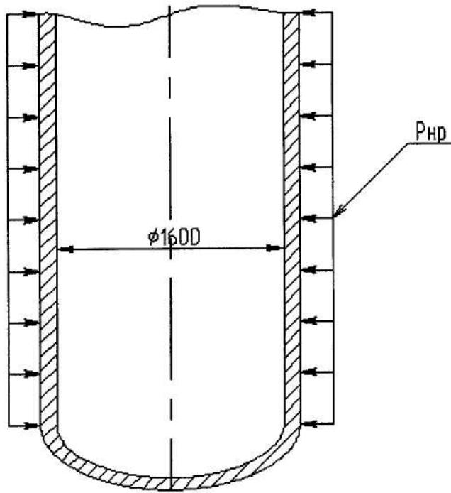
Рисунок 8.1 – Схема к определению толщины стенки обечайки
