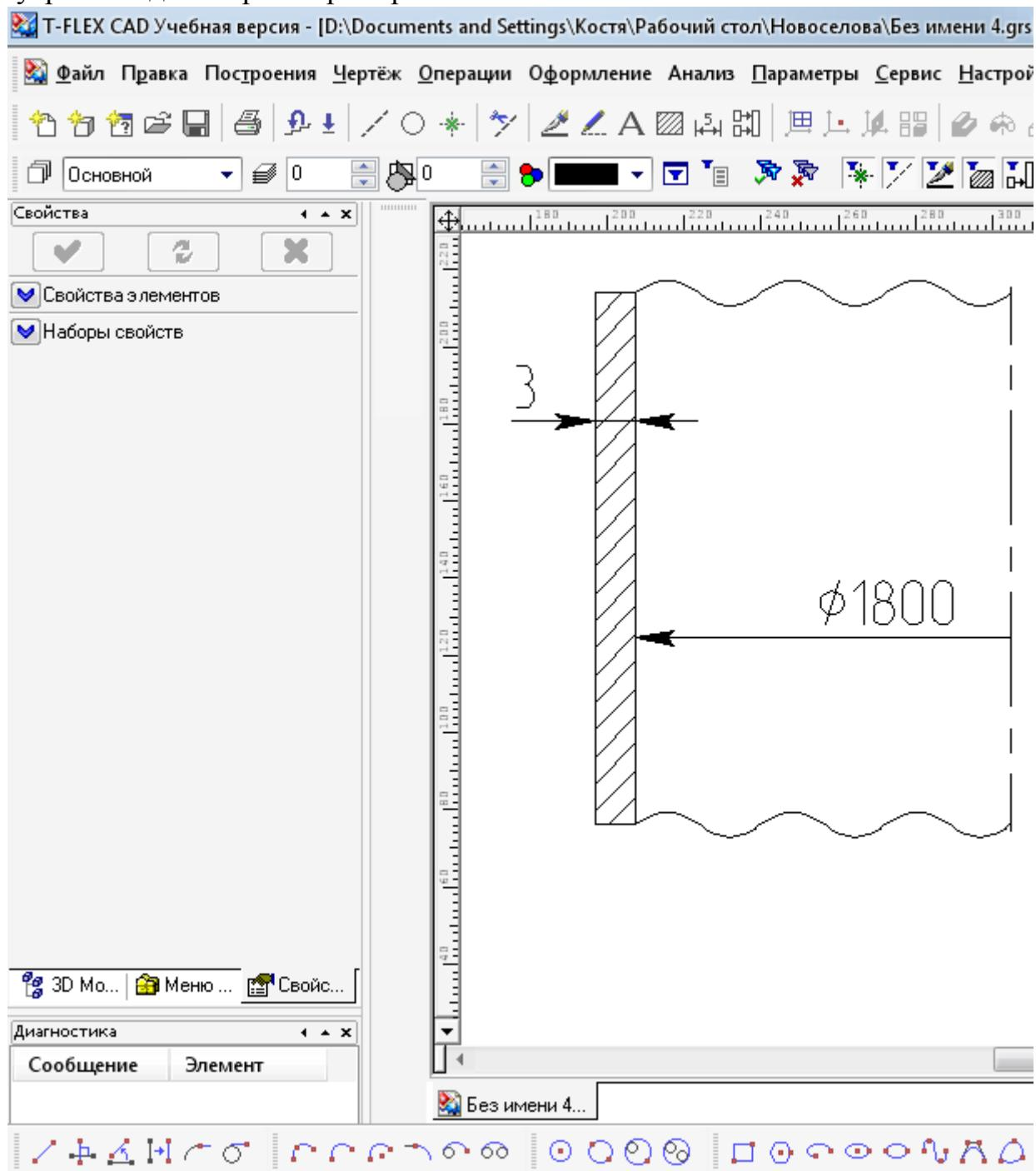
Рисунок 12.8 – Пример графической модели цилиндрической обечайки
