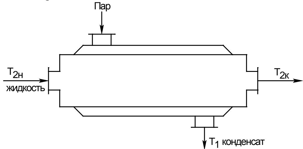
Рисунок 7.1 – Схема теплообменного аппарата “труба в трубе”
