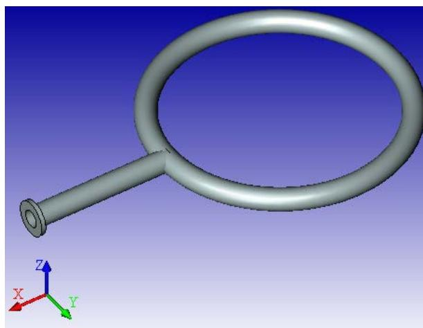
Рисунок 11.3 – 3D–модель узла ввода водяного пара
