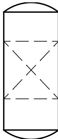
Рисунок 9.4 – Изображение абсорбера на технологической схеме
