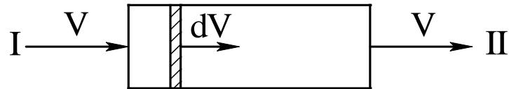
Рисунок 5.2 – Схема малого объема, движущегося в потоке идеально-го вытеснения
