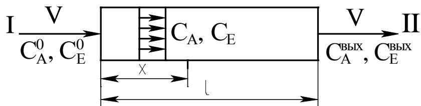
Рисунок 5.4 – Схема к расчету реактора идеального вытеснения
