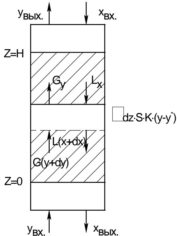
Рисунок 6.1 – Структура потоков фаз в абсорбере для модели идеального вытеснения:  $x_{\text{вх.}}, x_{\text{вых.}}$  - концентрации поглощаемого компонента в жидкости на верху и внизу абсорбера, кг/кг жидкого поглотителя;  $y_{\text{вх.}}, y_{\text{вых.}}$  – концентрации поглощаемого компонента в газе в низу и на верху абсорбера, кг/кг инертного газа
