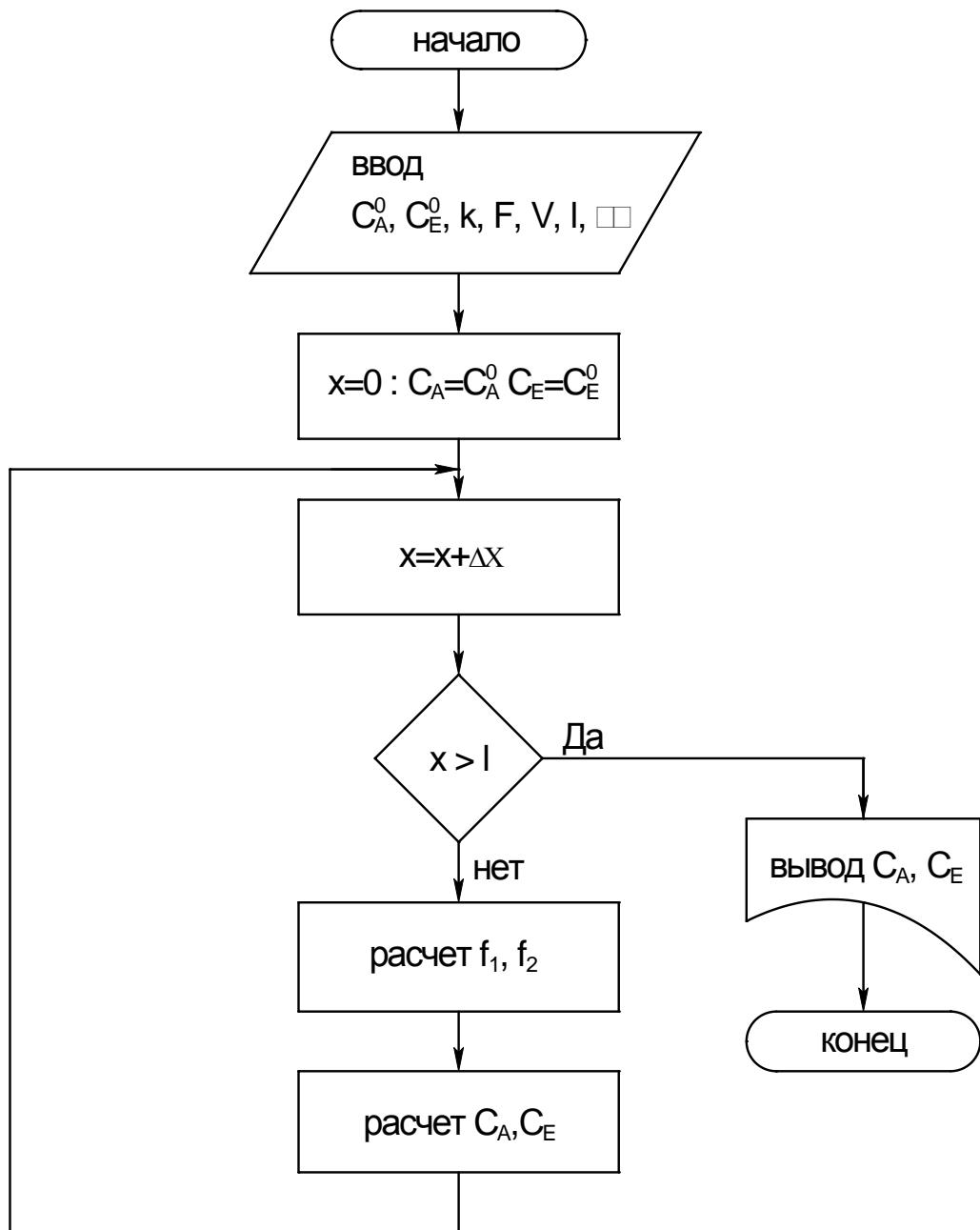
Рисунок 5.5 – Алгоритм расчета реактора идеального вытеснения
