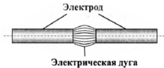
Рис.3. Принцип работы дуговой лампы
