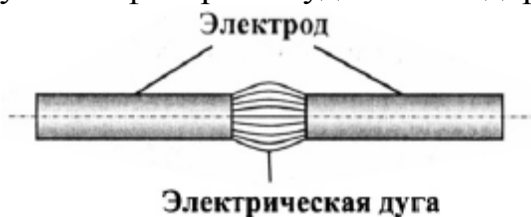
Рис.3. Принцип работы дуговой лампы
