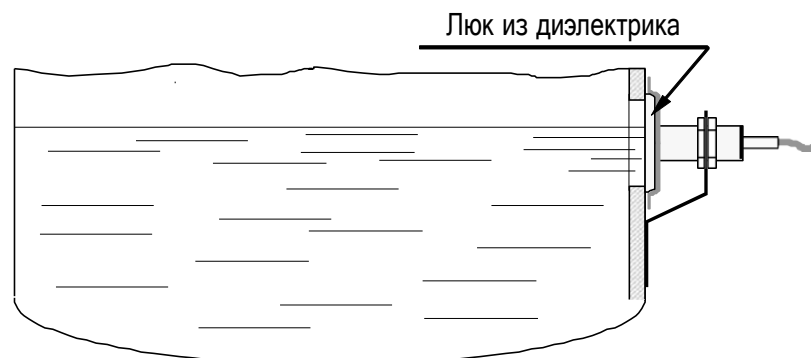
Рисунок 7 – Пример монтажа выключателей для контроля уровня жидкости
