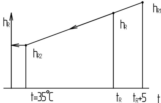
Рисунок 2.1 – Схема нахождения  $h_{R2}$ :  $h_{R1}$  и  $h_R$  – приняты по результатам расчета колонны
