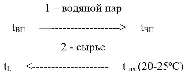
Затем определяем разности температур теплоносителей на концах теплообменника:
