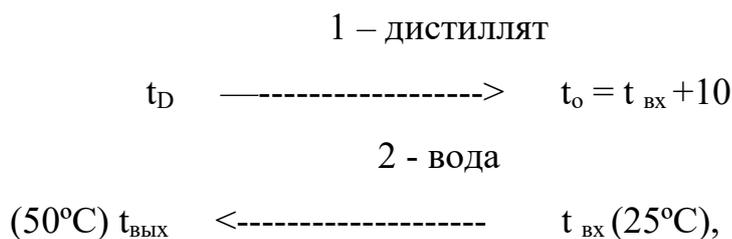
где  $t_D$  – температура паров дистиллята, °С;  $t_o$  - температура дистиллята в емкости орошения, °С (принимается по результатам расчета колонны).
