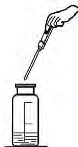
Рисунок 9. Соединение шприца-дозатора с пипеткой для титрования
