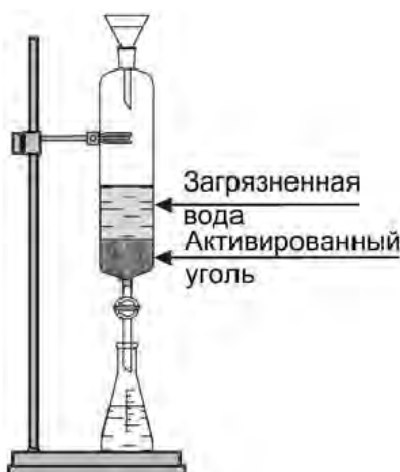
Рисунок 12. Установка для очистки воды адсорбцией
