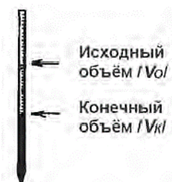
Рисунок 10. Определение израсходованного хлорида бария
