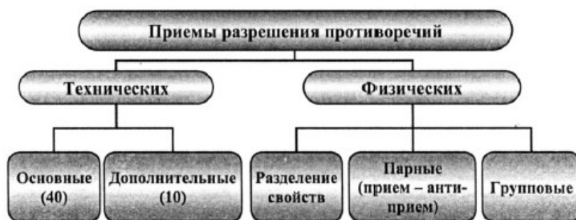
Рис. 1. Схема приемов разрешения противоречий
