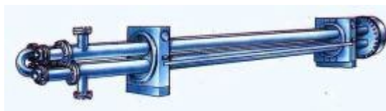
Рисунок 3.1 – Общий вид теплообменника «труба в трубе»
