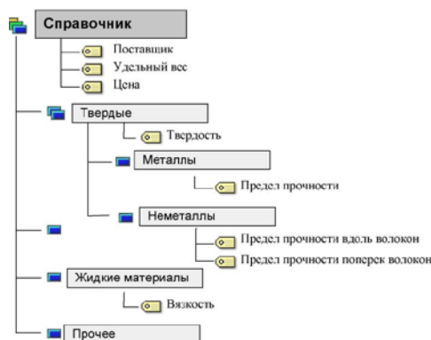
Рис. 4 - Пример задания характеристик для справочника в целом и его отдельных элементов
