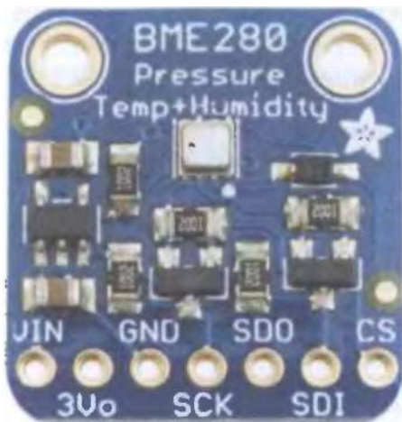
Рис. 116 ❖ Первый вариант сенсора BME280
