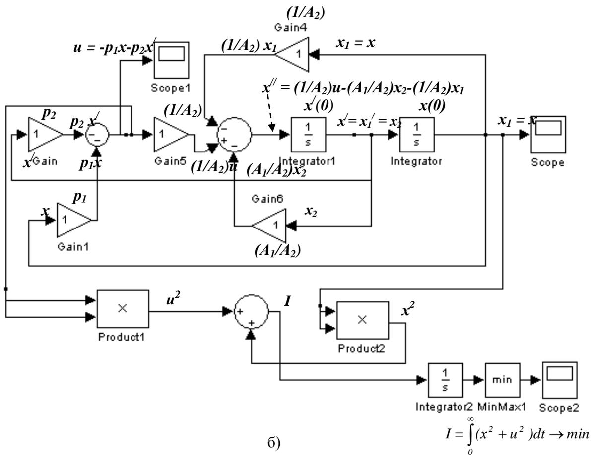
Рисунок 1 – Структурная схема оптимальной системы управления
