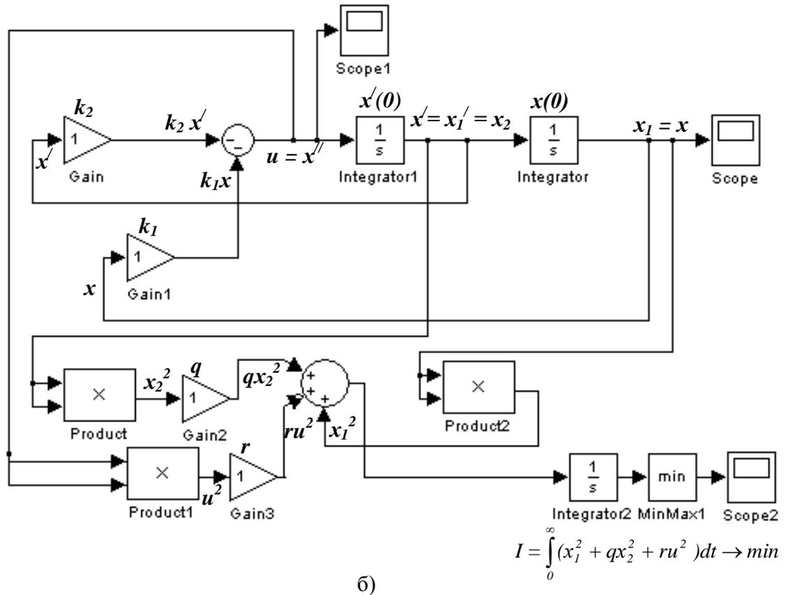
Рисунок 2 – Структурная схема оптимальной системы управления
