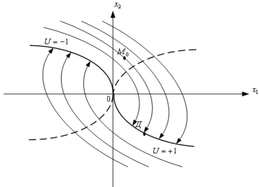
Рисунок 3.1 – График процесса управления на фазовой плоскости
