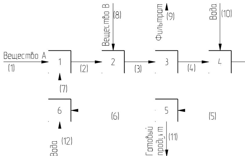
Рисунок 1.1 – Схема к расчету параметров замкнутой ХТС
