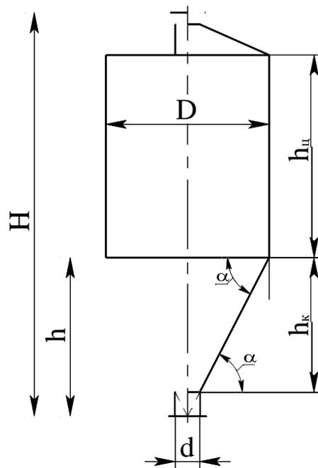
Рисунок 6.1 – Схема к определению размеров цилиндроконического бункера
