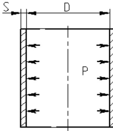
Рисунок 6.1 – Схема к расчету толщины стенки корпуса сосуда
