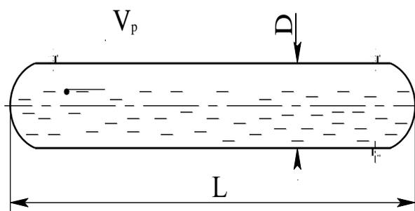
Рисунок 5.1 – Схема к определению размеров емкости
