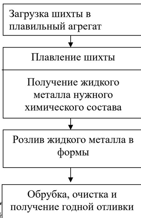
Рисунок 1 – Схема получения отливок. Массу отливки, лилей определяют опытно-производственным методом. При этом количество одновременно взвешиваемых деталей зависит от массы каждой детали.
