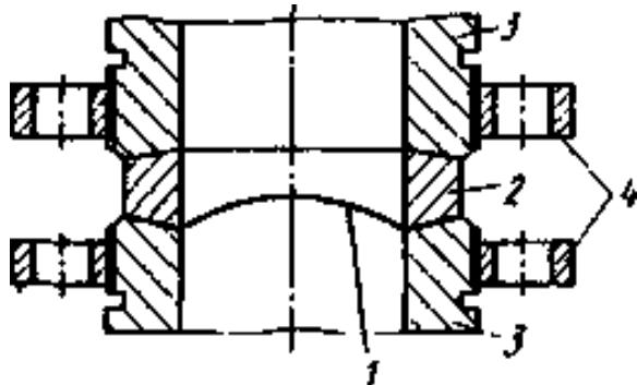
Рисунок 9.2 – Линзовый зажим разрывной мембранны: 1 – мембрана, 2 – коническая шайба, 3 – торцы сбросной магистрали, 4 – соединительные фланцы
