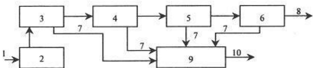
Рисунок 6.1 – Общая схема очистки сточных вод: 1 – необработанные сточные воды; 2 – устройство для регулирования состава и расхода сточных вод; 3 – сооружения механической очистки; 4 – сооружения других методов очистки; 5 – сооружения глубокой очистки; 6 – сооружения по обеззараживанию сточных вод; 7 – осадок или избыточная биомасса; 8 – очищенные сточные воды; 9 – сооружения по обработке осадка; 10 – обработанный осадок
