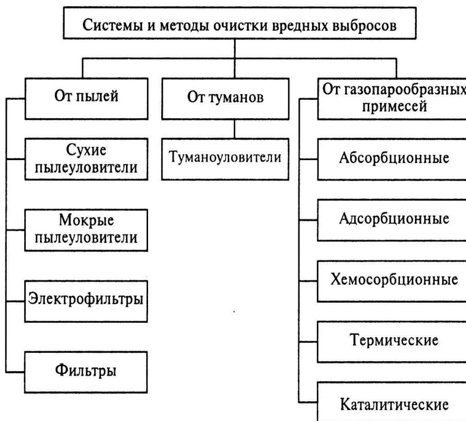
Рисунок 2.1 – Схема классификации систем и методов очистки атмосферных выбросов
