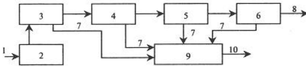
Рисунок 6.1 – Общая схема очистки сточных вод: 1 – необработанные сточные воды; 2 – устройство для регулирования состава и расхода сточных вод; 3 – сооружения механической очистки; 4 – сооружения других методов очистки; 5 – сооружения глубокой очистки; 6 – сооружения по обеззараживанию сточных вод; 7 – осадок или избыточная биомасса; 8 – очищенные сточные воды; 9 – сооружения по обработке осадка; 10 – обработанный осадок
