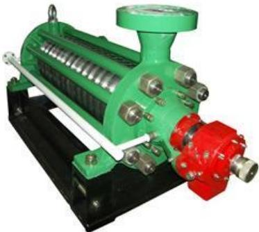
Насосы типа ЦНС-240/1900 2ТМ (см. рис.1) применяются для перекачки технологической жидкости плотностью 1013 кг/м<sup>3</sup> в общий коллектор на КНС ОАО «ГАЗПРОМНЕФТЬ-ННГ». В настоящее время на всех КНС применяется нерегулируемый синхронный электропривод типа СТД-1600 (Рном=1600 кВт, Уном=6кВ, Iном=178А, КПД=0.97, cosφ=0.9, n=3000 об./мин.). Прямой пуск приводит к значительным перегрузкам на электродвигателях из-за больших и продолжительных пусковых токов.
