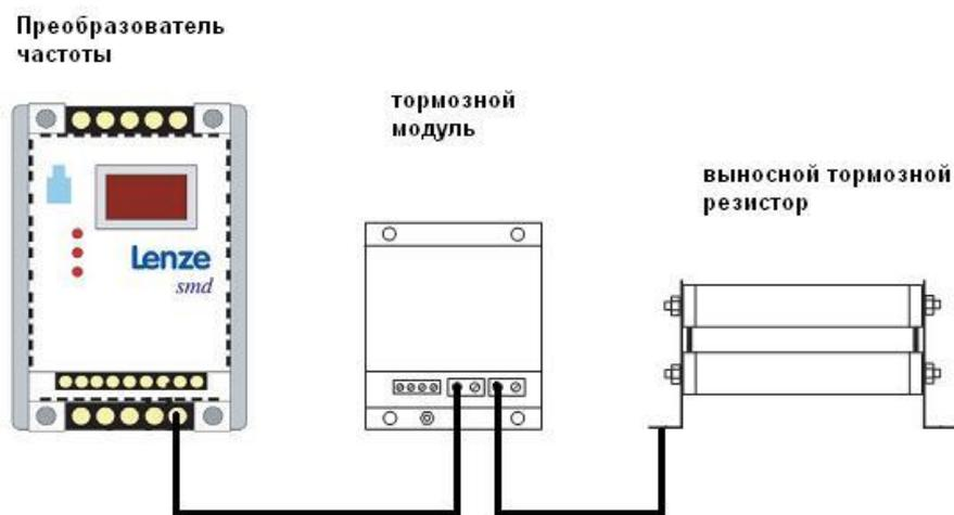
При торможении асинхронный двигатель работает в режиме генератора, его отдаваемая электрическая энергия способна вызвать перенапряжение в сети постоянного тока, для гашения этого эффекта применяют тормозные резисторы.
