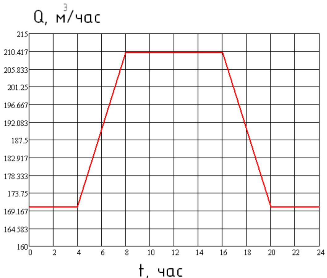
Рис.6 График зависимости суточной нагрузки насосного оборудования (типовой)
