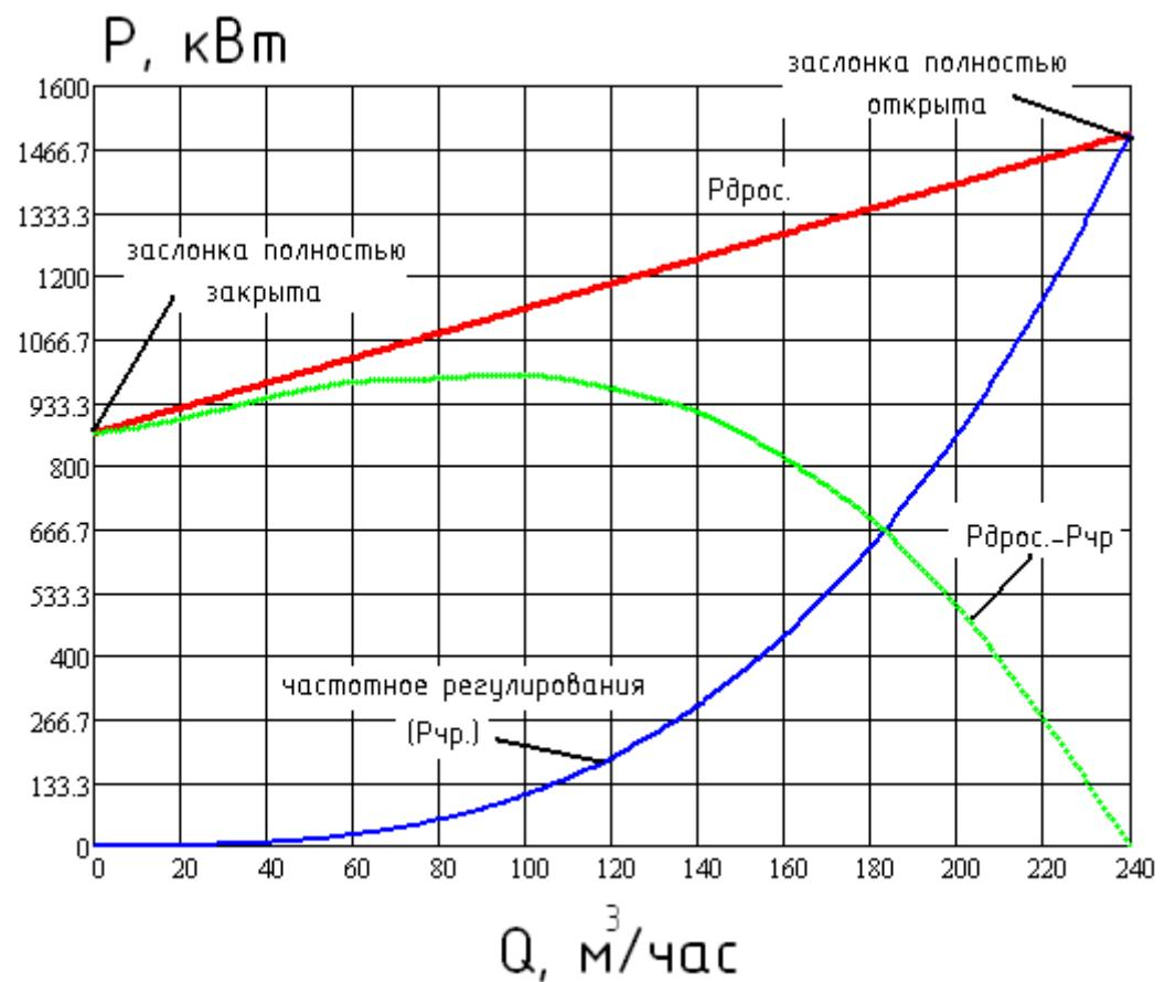
Рис. 5 Зависимость экономии потребляемой насосом из электросети мощности
