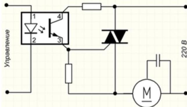
Рис. №3.Схема тиристорного регулирования однофазного асинхронного электродвигателя.
