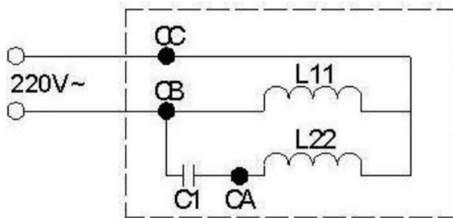
Рис. №8. Схема присоединения однофазного асинхронного двигателя через конденсатор
