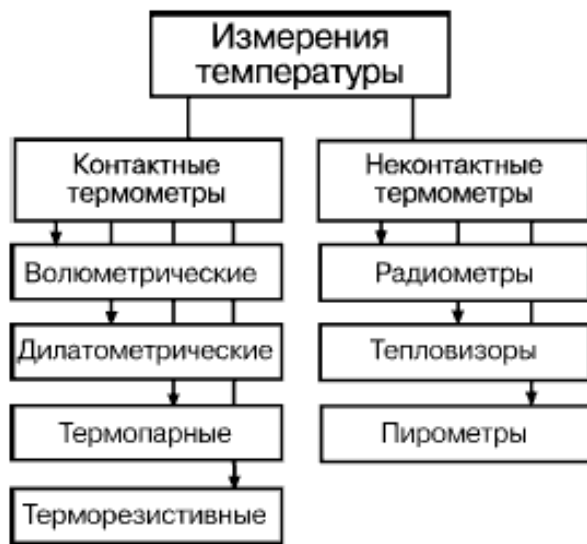
Рис.2.1. Классификация методов измерения температуры
