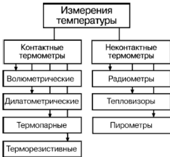
Рис.2.1. Классификация методов измерения температуры
