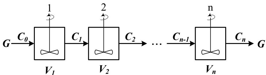
Рисунок 4.5 – Схема аппарата, описываемого ячеичной моделью
