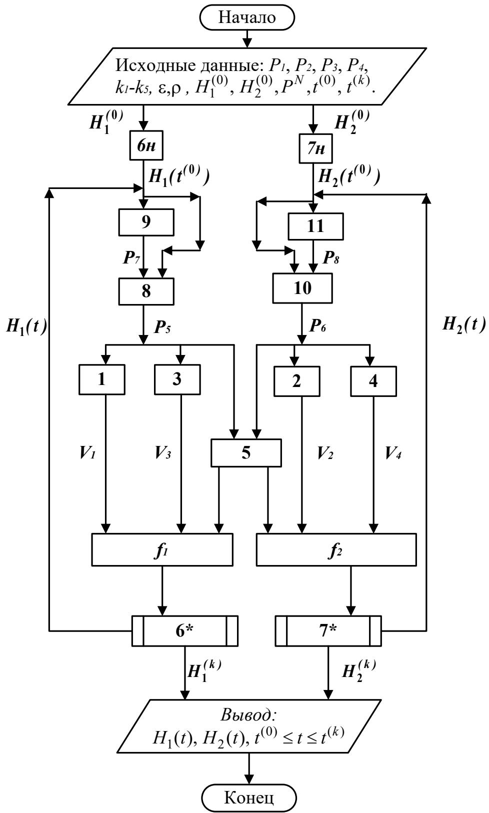
Рисунок 5.2 – Блок-схема алгоритма расчета нестационарного режима гидравлической системы
