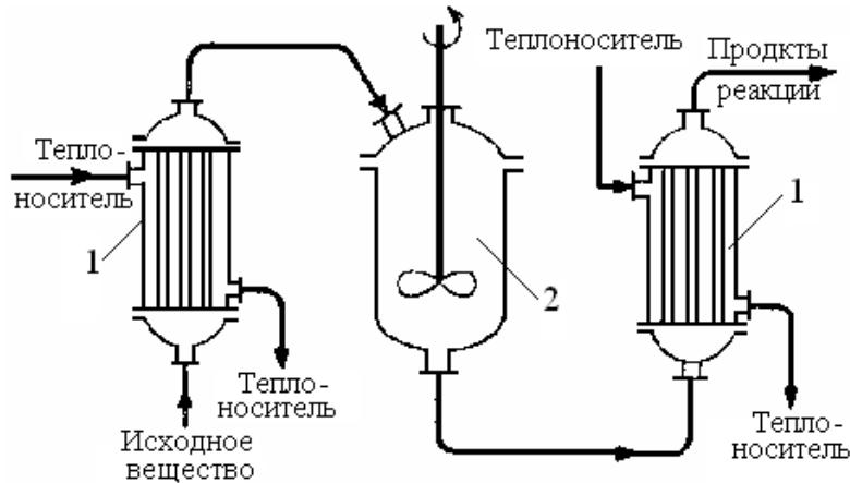
Рисунок. 2 – Реактор смещения, работающий
