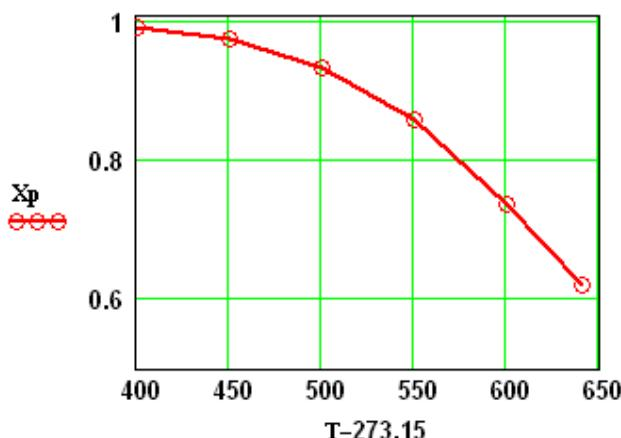
Рисунок 2 – Зависимость равновесной степени превращения  $X_p$  от температуры
