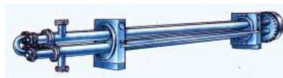
Рисунок 3.1 – Общий вид теплообменника «труба в трубе»
