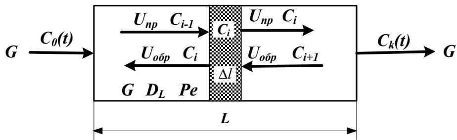
Рисунок 4.7 – Схема аппарата, имеющего однопараметрическую диффузионную модель
