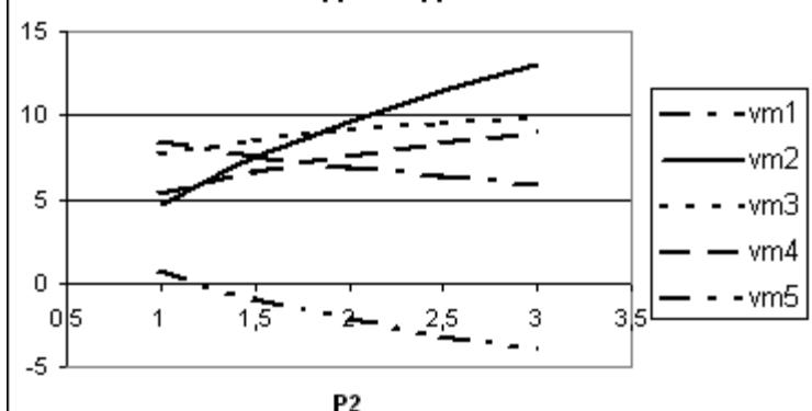
Рисунок 3 – Статистические характеристики гидравлической системы: изменения режимных параметров в зависимости от одного из давлений на выходе –  $P_2$
