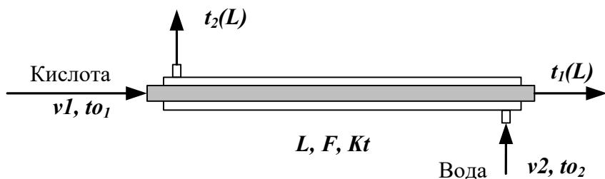
Рисунок 4.1 – Схема для расчета противоточного теплообменника
