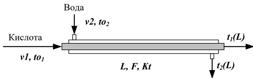
Рисунок 3.3 – Схема для расчета прямоточного теплообменника
