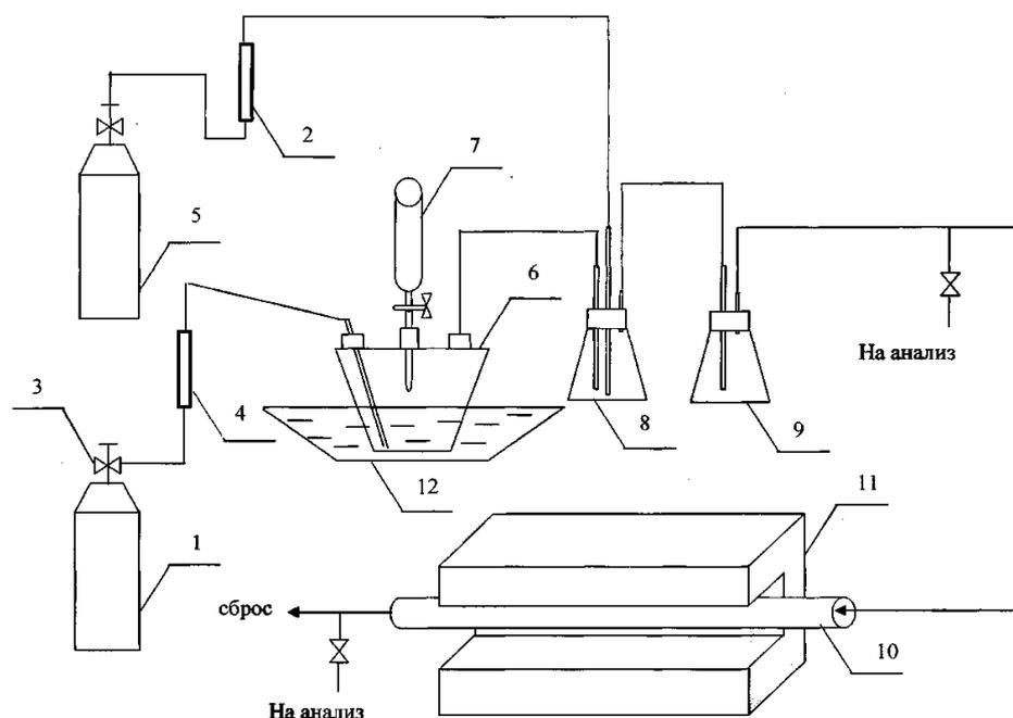
1 – баллон с азотом; 2, 4 – ротаметр; 3 – вентиль тонкой регулировки; 5 – баллон с аммиаком; 6 – трехгорлая колба; 7 – капельная воронка; 8 – смеситель; 9 – каплеотбойник; 10 – кварцевый реактор; 11 – печь; 12 – охлаждающая емкость.
