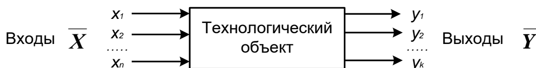
Рисунок 6.1 – Изображение технологического объекта в виде «черного ящика»
