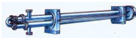
Рисунок 4.1 – Общий вид теплообменника «труба в трубе»
