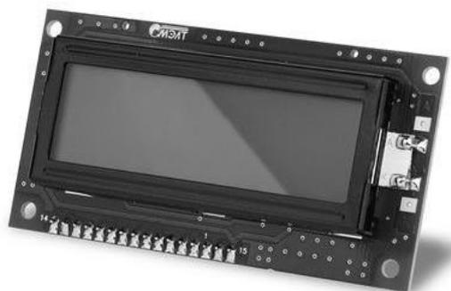
Рис. 4.1. Дисплей LCD 1602
