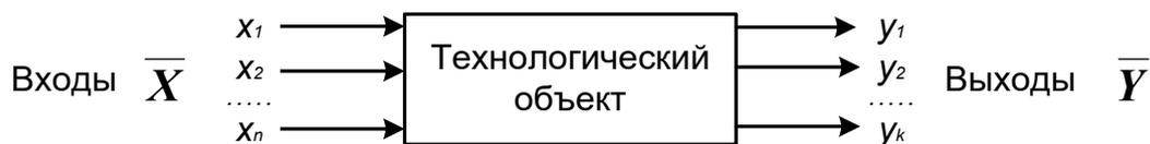
Рисунок 6.1 – Изображение технологического объекта в виде «черного ящика»
