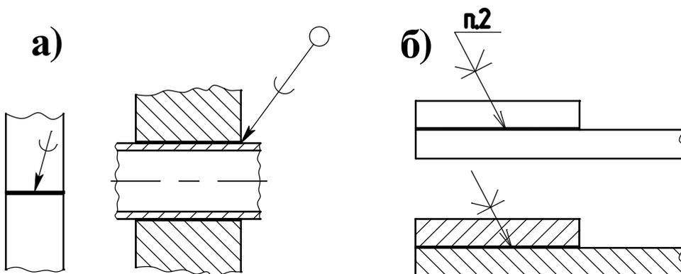
Рисунок 3.46 – Обозначение пайки
