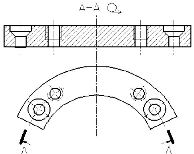
Рисунок 2.20 – Использование цилиндрической поверхности в качестве секущей.
