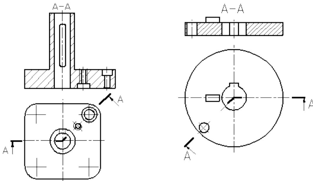
Рисунок 2.10 – Построение ломаного разреза.
