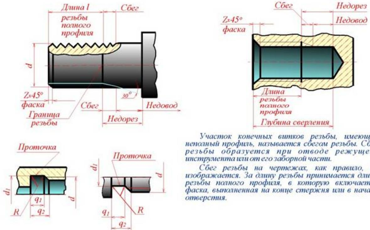
Участок конечных витков резьбы, имеющих неполный профиль, называется сбегом резьбы. Сбег резьбы образуется при отводе режущего инструмента или от его заборной части.
