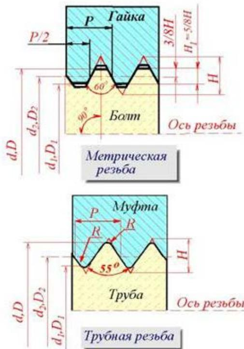
Рисунок 3.4 – Параметры метрической и трубной резьб
