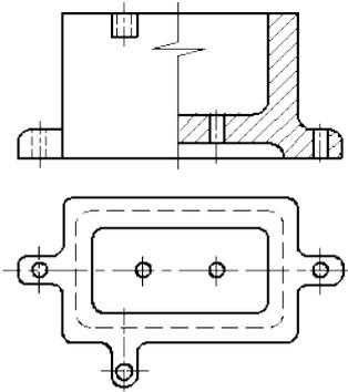
Рисунок 2.16 – Совмещение на изображении части вида и разреза.
