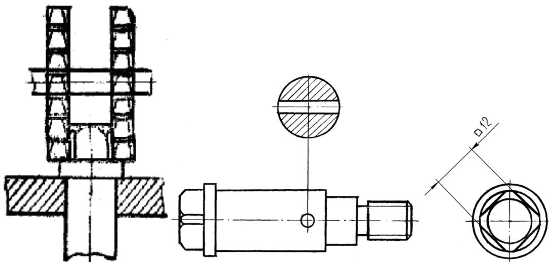
Рисунок 4.32 - Фрезерование головки винта под ключ
