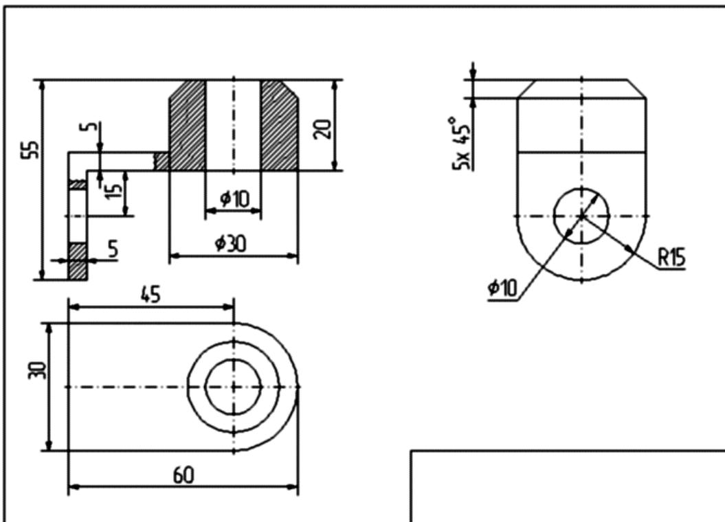
Рисунок. 4.6 – Шаг 4 построения эскиза кронштейна
