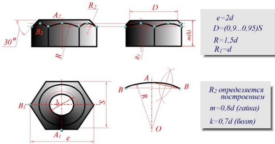
Рисунок 20.16 - Гайка
