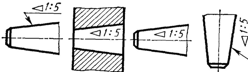
Рисунок 4.24 - Конусность при угле меньше  $28^\circ$
