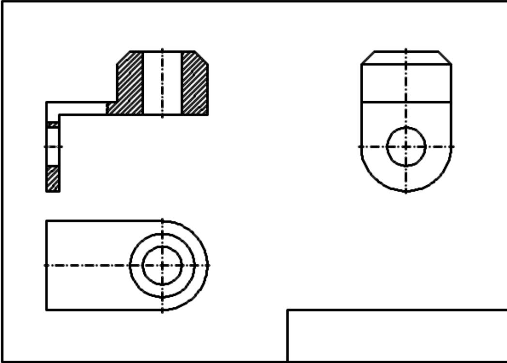
Рисунок. 4.5 – Шаг 3 построения эскиза кронштейна
