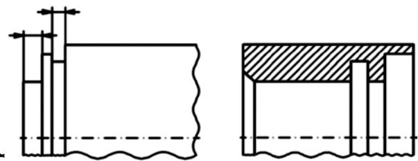
Рисунок 4.10 – Размеры проточки
