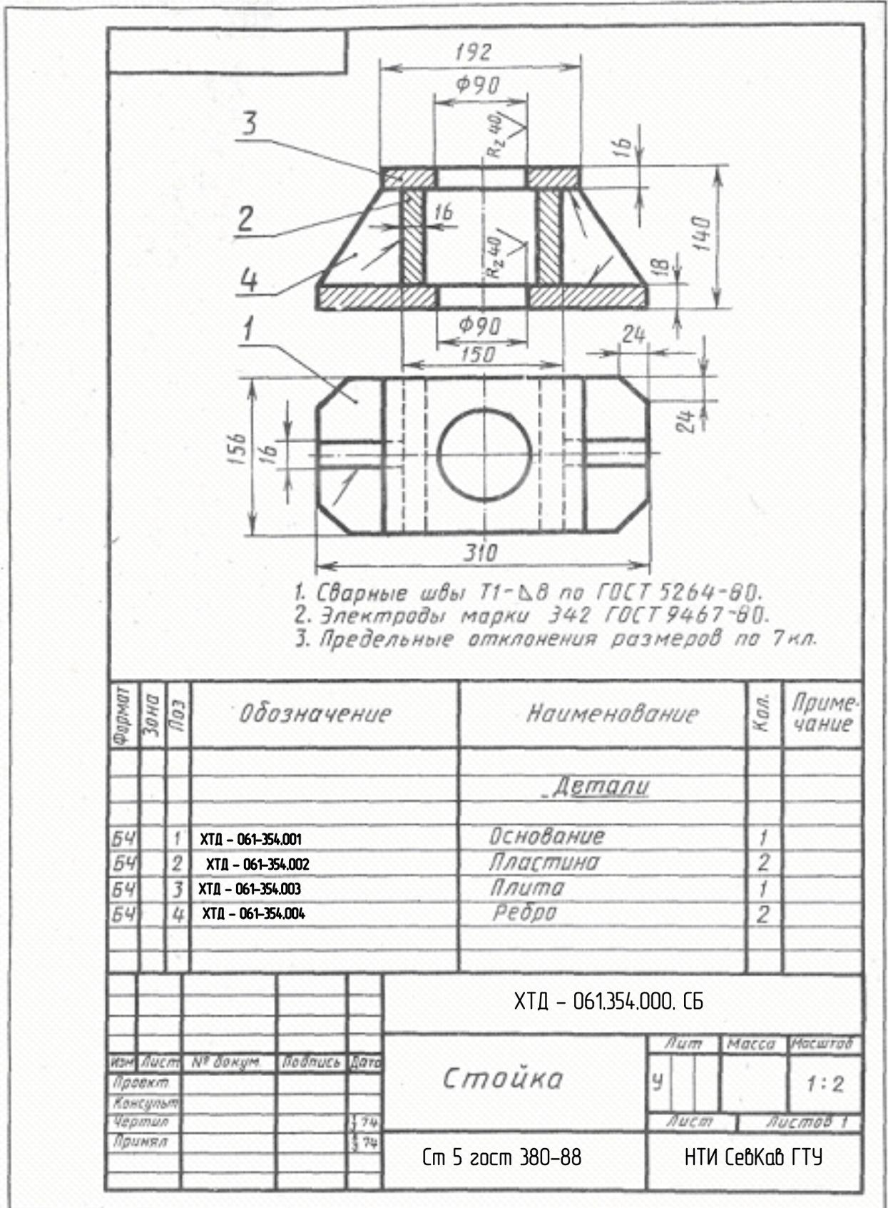
Рисунок 3.53 – Пример выполнения чертежа сварной детали
