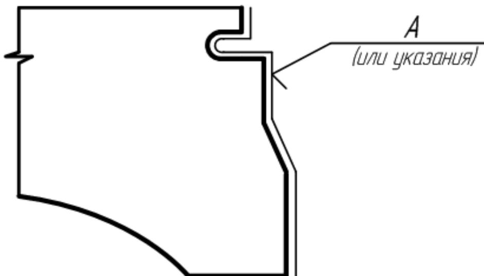
Рисунок 4.41 – Обозначение покрытия
