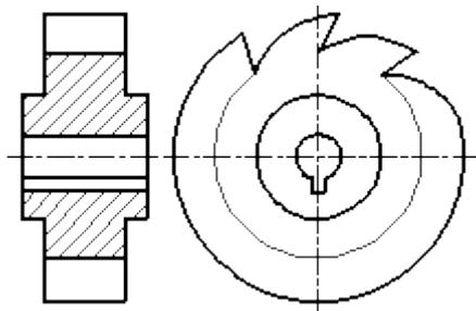
Рисунок 2.30 – Образец изображения равномерно расположенных элементов.
