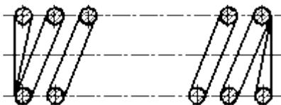
Рисунок 2.8 – Продольный разрез пружины.
