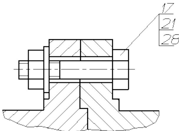
Рисунок 8. Пример группы крепежных деталей на сборочном чертеже
