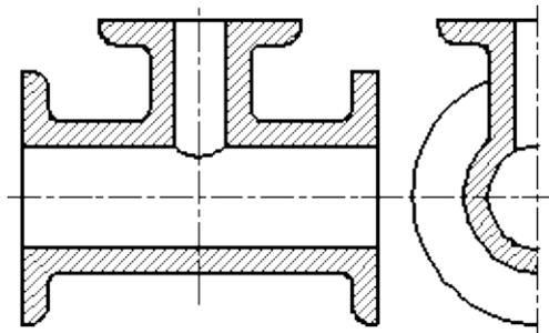
Рисунок 2.33 – Образец оформления линий перехода поверхностей.
