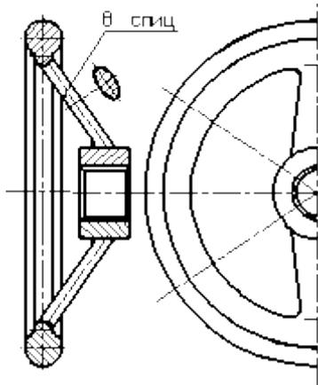
Рисунок 2.31 – Образец изображения равномерно расположенных элементов (8 спиц)
