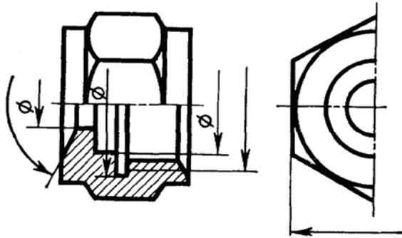
Рисунок 4.25 – Постановка размеров при соединении вида и разреза
