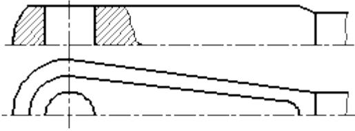
Рисунок 2.34 – Образец оформления линий пересечения поверхностей.
