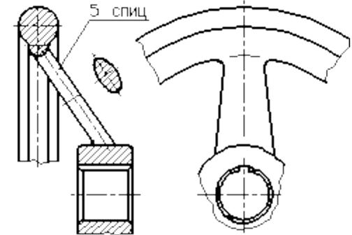
Рисунок 2.32 – Образец изображения равномерно расположенных элементов (5 спиц)
