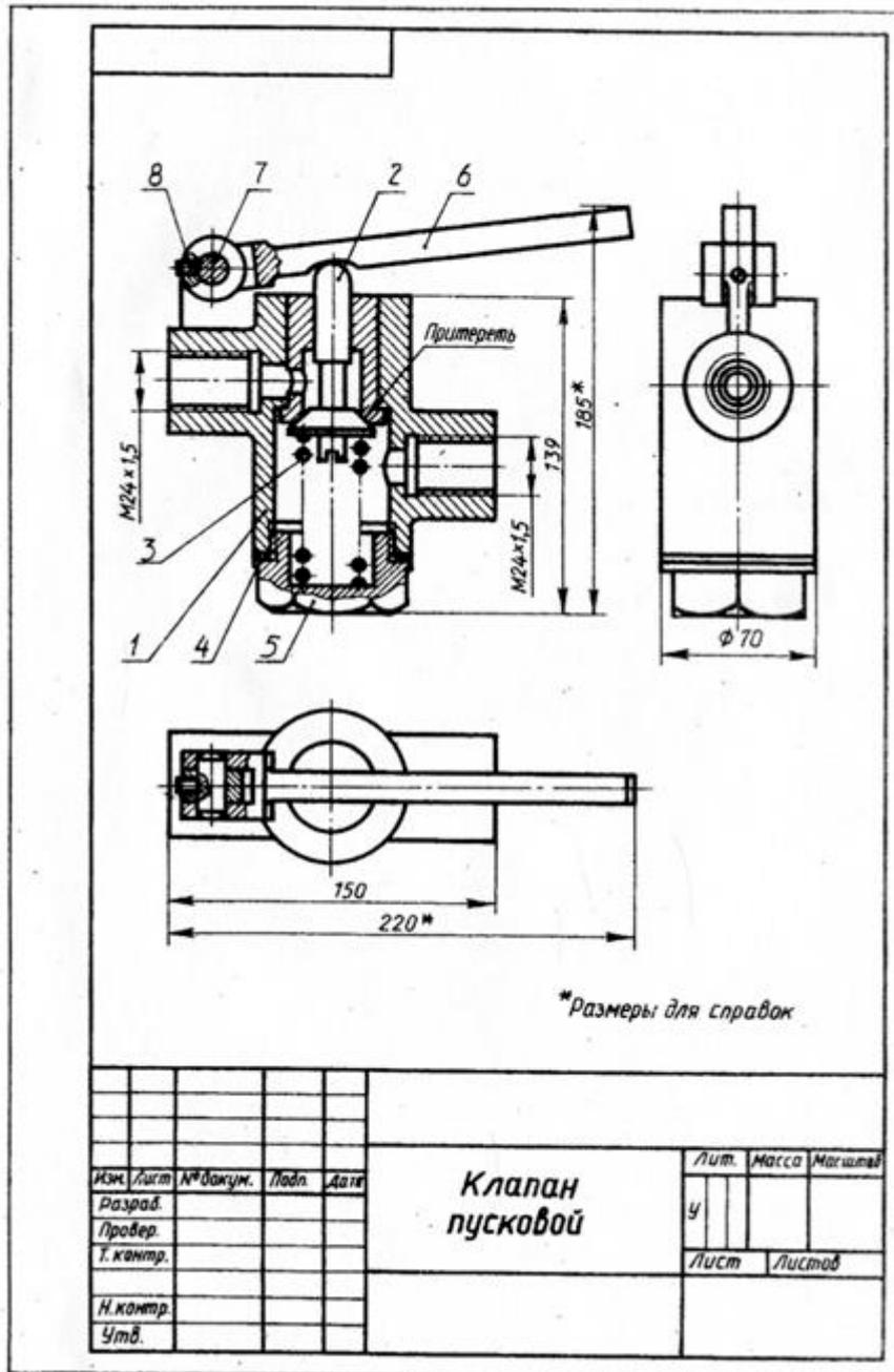
Построение изображений начинают с наиболее крупной детали, вычерчивая её контур (дет. поз. 1 рисунок 5.20). затем к ней присоединяют более мелкие (поз. 5, 2 и т.д.) и выполняют необходимые разрезы, сечения, показывают резьбу и пр.
