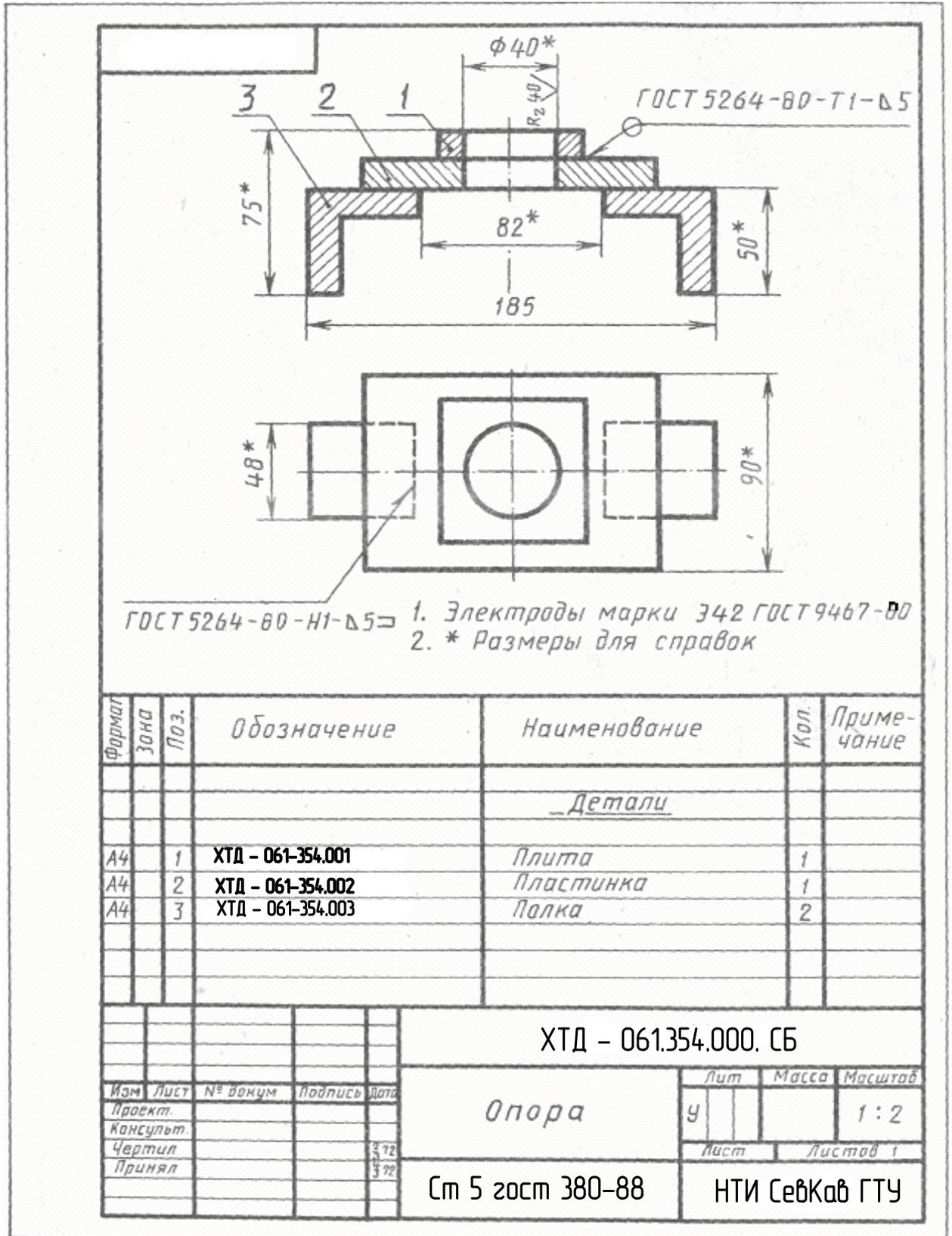
Рисунок 3.52 – Пример выполнения чертежа сварной детали
