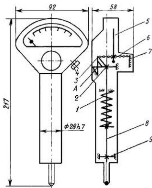
Рисунок 7.1. Схема микрокатора
