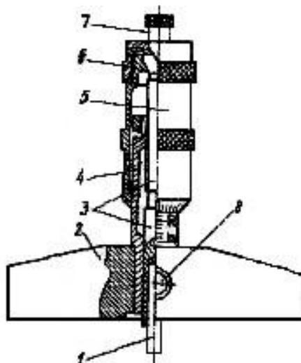
**Рис. 5.3.** Микрометрический глубиномер
