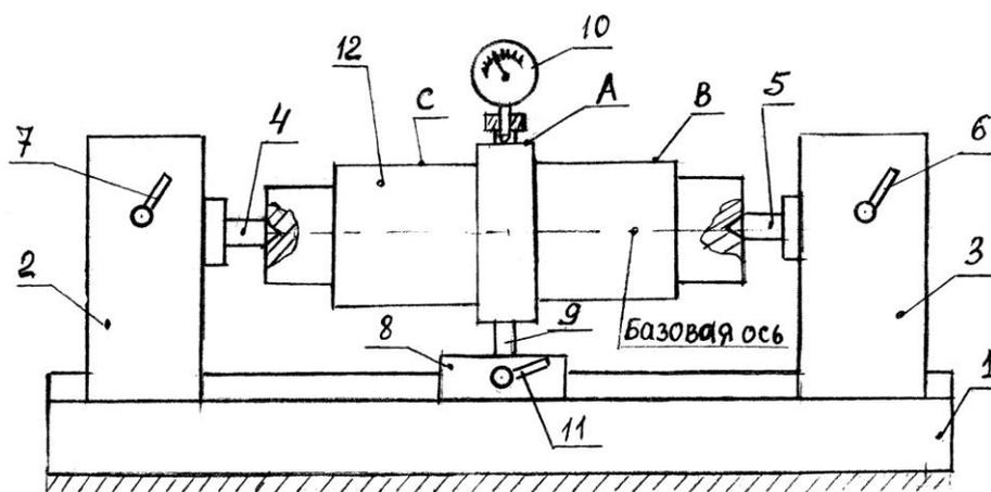
Рис. 8.1. Приспособление для измерения биения
