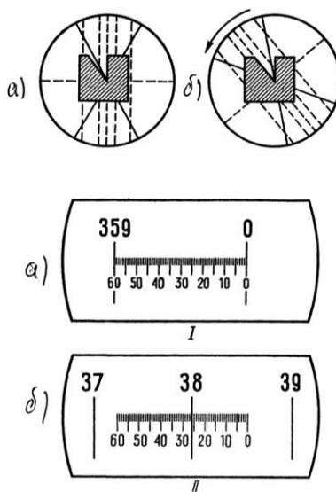
Рис. 10.2. Показания: I — 0, II —  $38^\circ 26'$ . Результат измерения:  $38^\circ 26'$
