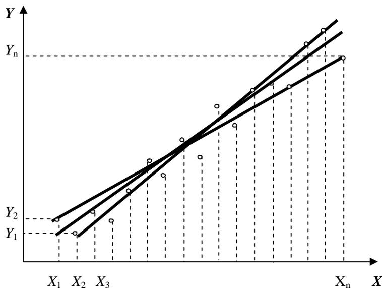
*Рис.1.1. Построение линейной градуировочной характеристики по экспериментальным данным*
