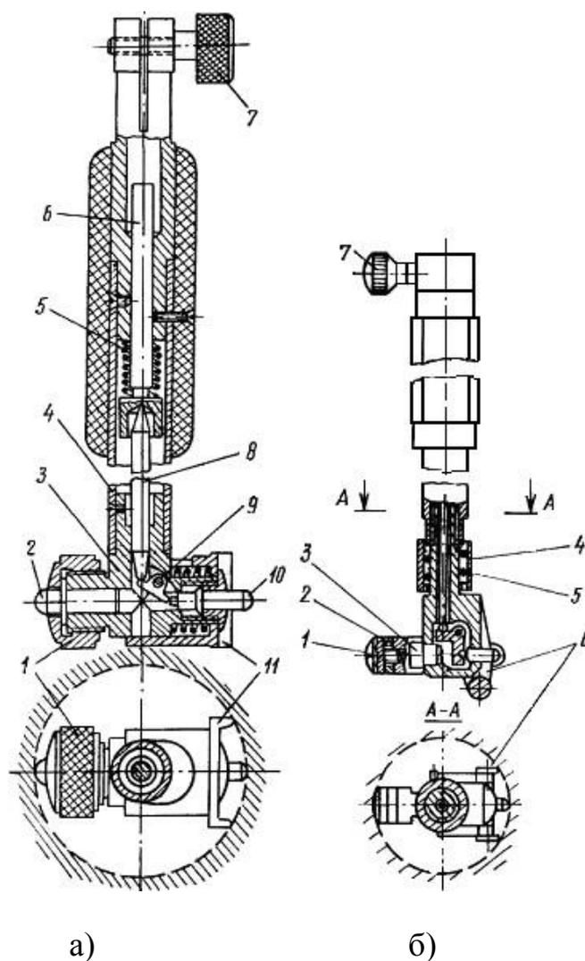
**Рис. 6.3.** Устройство индикаторного нутромера
