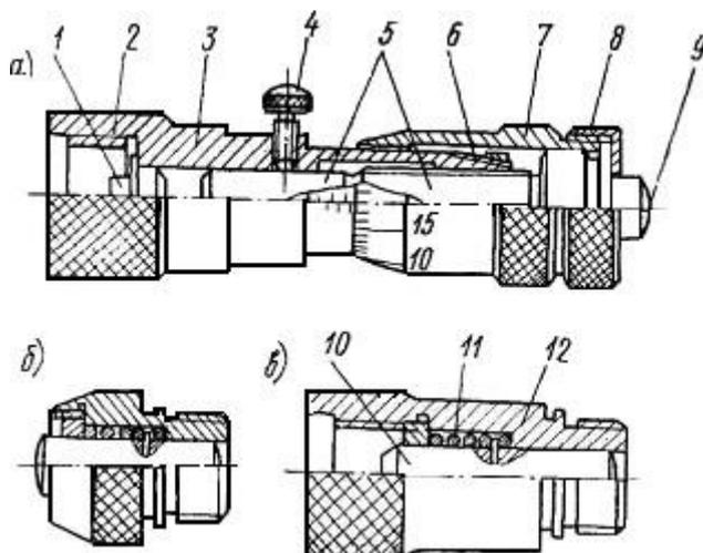
Рис. 5.2. Микрометрический нутромер
