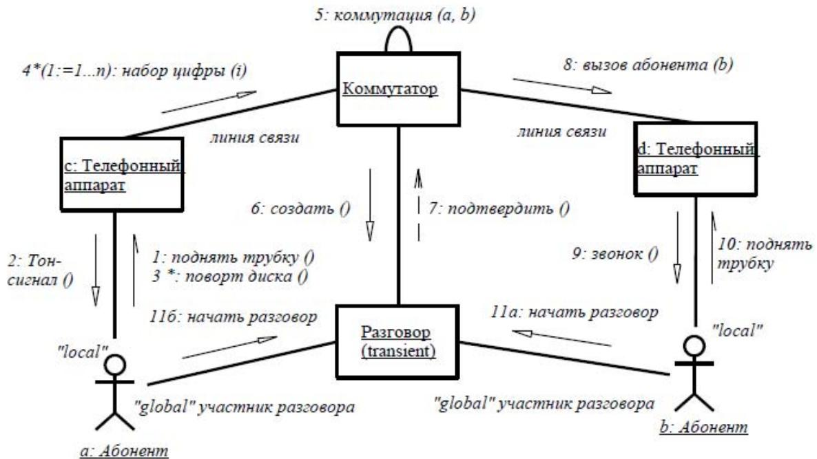
*Рис. 15. Окончательный вариант диаграммы кооперации для моделирования телефонного разговора*
