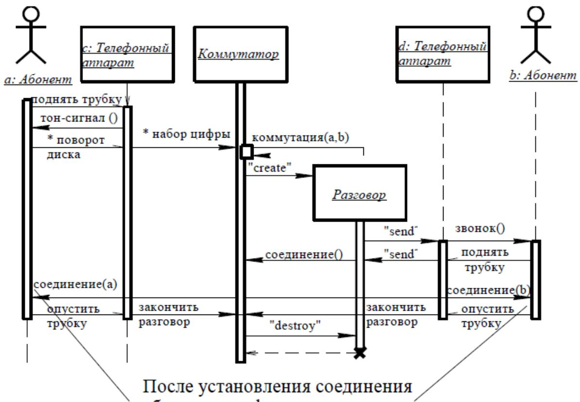
*Рис. 38. Окончательный вариант диаграммы последовательности для моделирования телефонного разговора*
