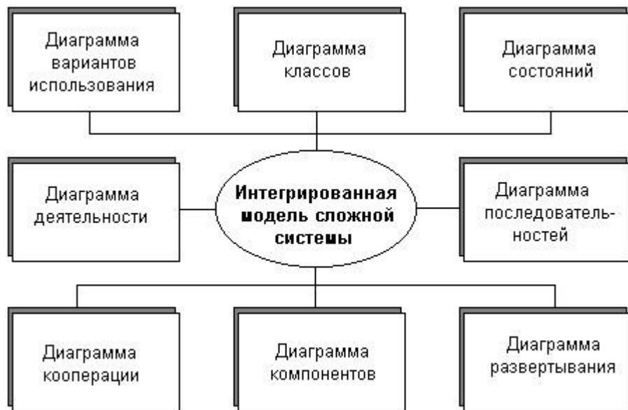
*Рис. 16. Интегрированная модель сложной системы в нотации UML*
