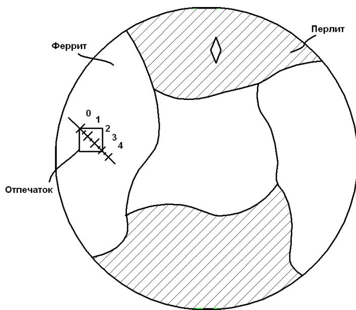
Рисунок 4.5 Исследование микротвердости материалов
