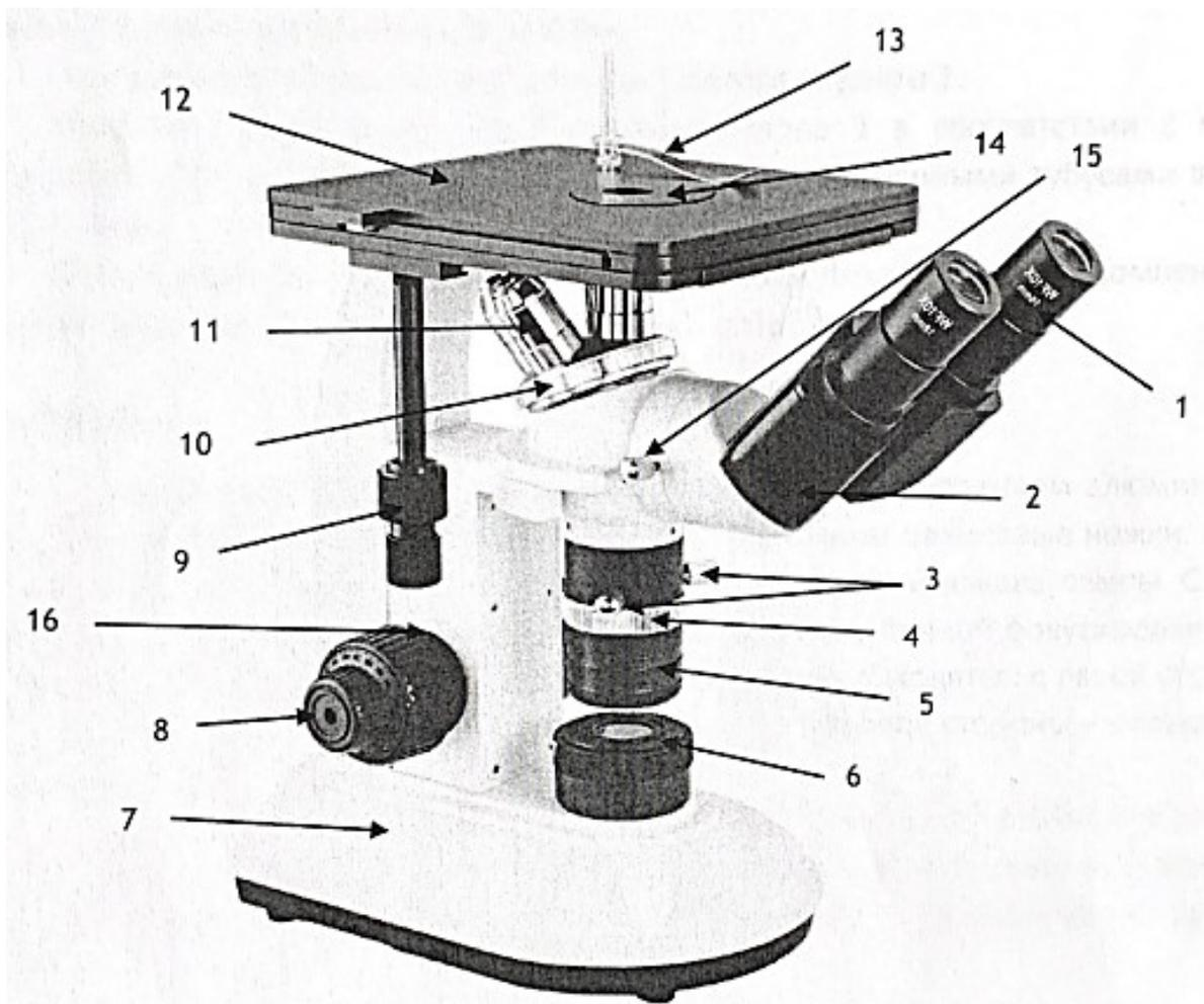
Рисунок 2.2 – Общий вид металлографического микроскопа Альтами MET 2С
