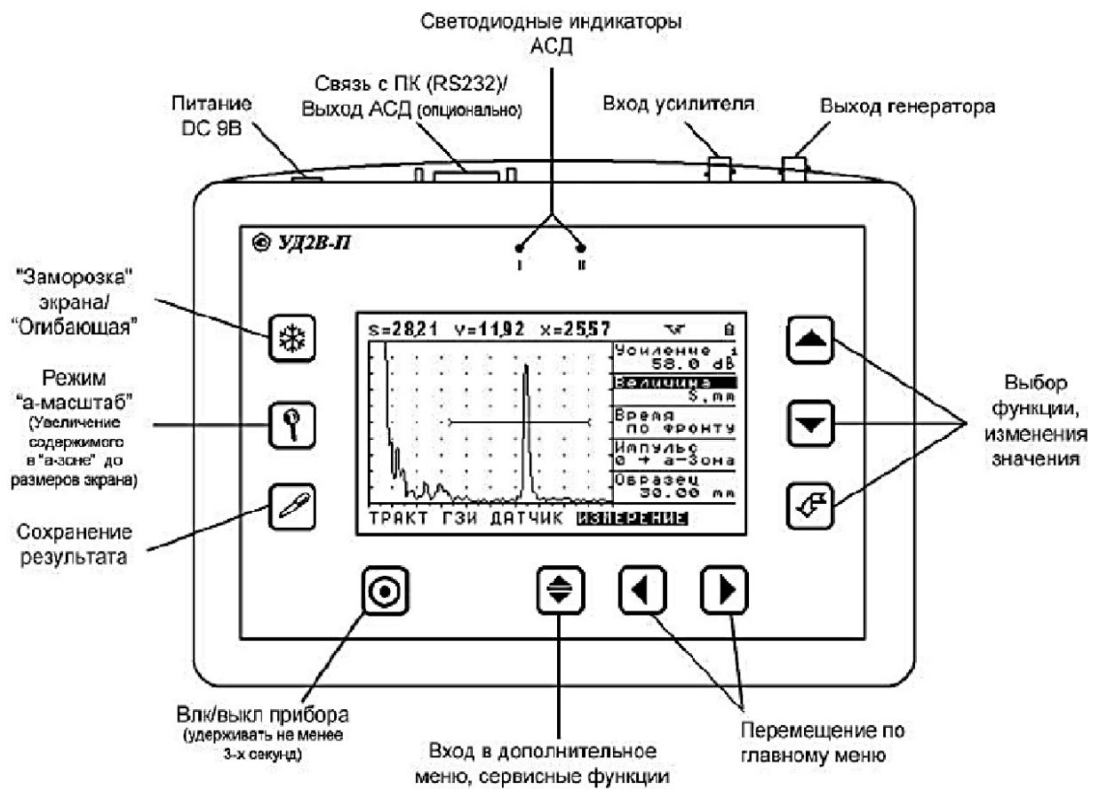
Рисунок 6.4 – Передняя панель дефектоскопа УД2В-П45 Lite
