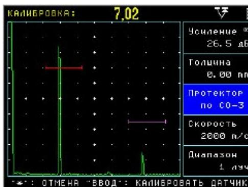
Рисунок 6.7 – Калибровка наклонного преобразователя по образцу СО-3
