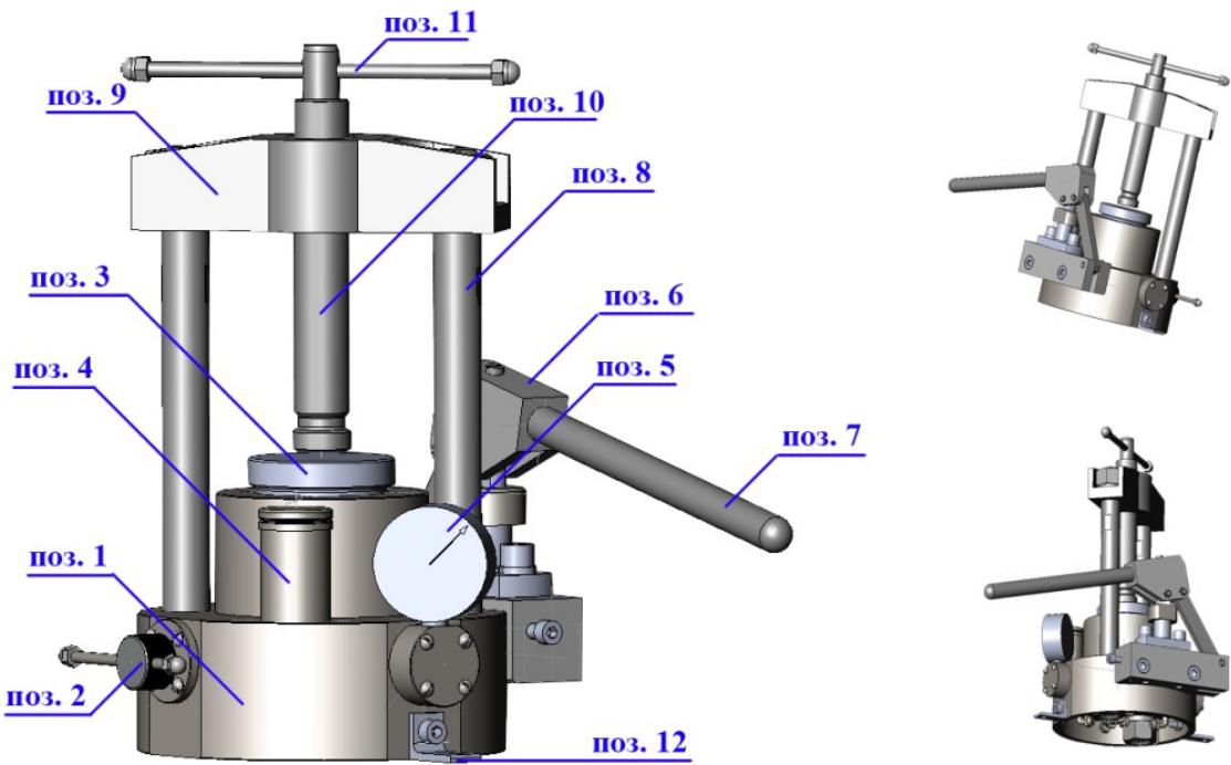
Рисунок 5.6 – Устройство пресса: 1 – корпус; 2 – выпускной винт; 3 – пятка; 4 – бак; 5 – манометр; 6 – ручной насос; 7 – ручка насоса; 8 – колонны; 9 – перекладина; 10 – прижимной винт; 11 – ручка винта; 12 – кронштейн.
