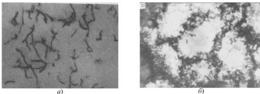
Рисунок 5.1 Примеры типов дислокационных субструктур ( $\times 30000$ ):
