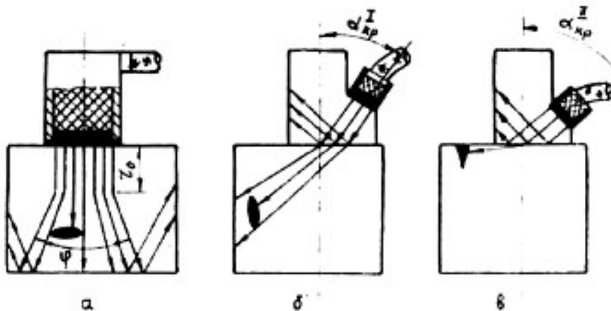
Рисунок 6.1 Схема получения и распространения ультразвуковых волн:
