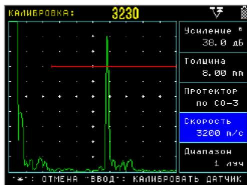
Рисунок 6.9 – Калибровка скорости в образце
