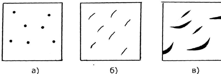
Рисунок 3.1 – Неметаллические включения в стали и в чугунах:
