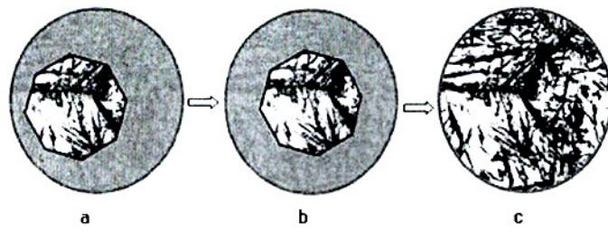
Рисунок 2.4 – Настройка межзрачкового расстояния
