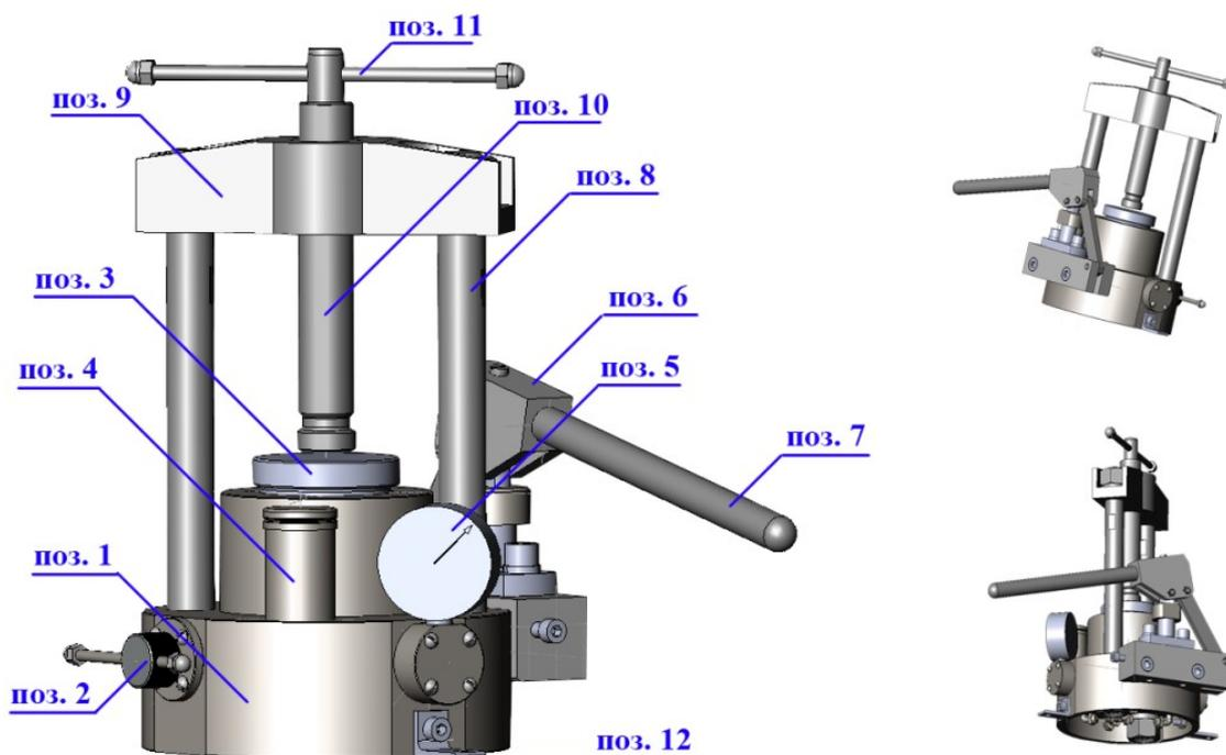
Рисунок 5.6 – Устройство пресса: 1 – корпус; 2 – выпускной винт; 3 – пятка; 4 – бак; 5 – манометр; 6 – ручной насос; 7 – ручка насоса; 8 – колонны; 9 – переключатель; 10 – прижимной винт; 11 – ручка винта; 12 – кронштейн.
