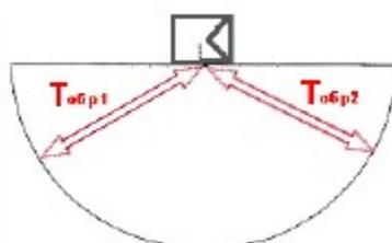
Рисунок 6.6 - Путь УЗ луча в образце СО-3
