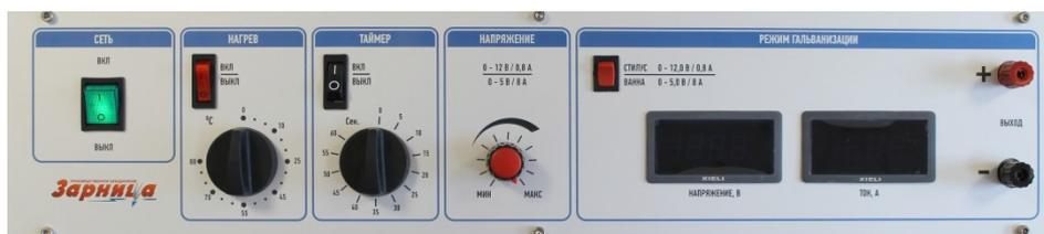
Рисунок 7.3 – Панель управления лабораторной установки
