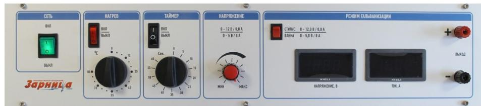
Рисунок 7.3 – Панель управления лабораторной установки
