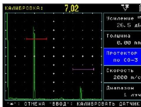
Рисунок 6.7 – Калибровка наклонного преобразователя по образцу СО-3
