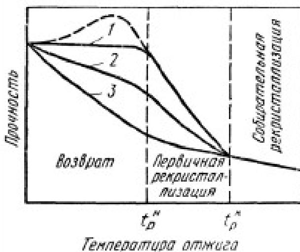
Рисунок 5.4 Схемы зависимостей прочностных свойств наклеченного металла от температуры отжига
