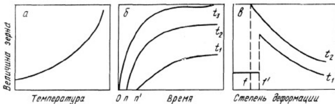
Рисунок 5.3 – Влияние температуры, продолжительности и степени деформации на величину рекристаллизованного зерна ( $t_1 < t_2 < t_3$ ,  $0n$  и  $0n'$  - продолжительность инкубационного периода;  $f$  и  $f'$  - критическая степень деформации)
