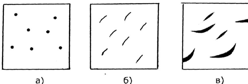
Рисунок 3.1 – Неметаллические включения в стали и в чугуне:
