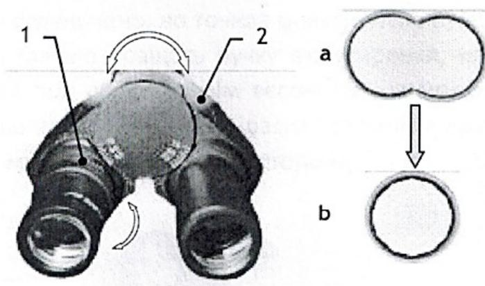
Рисунок 2.3 – Настройка резкости изображения
