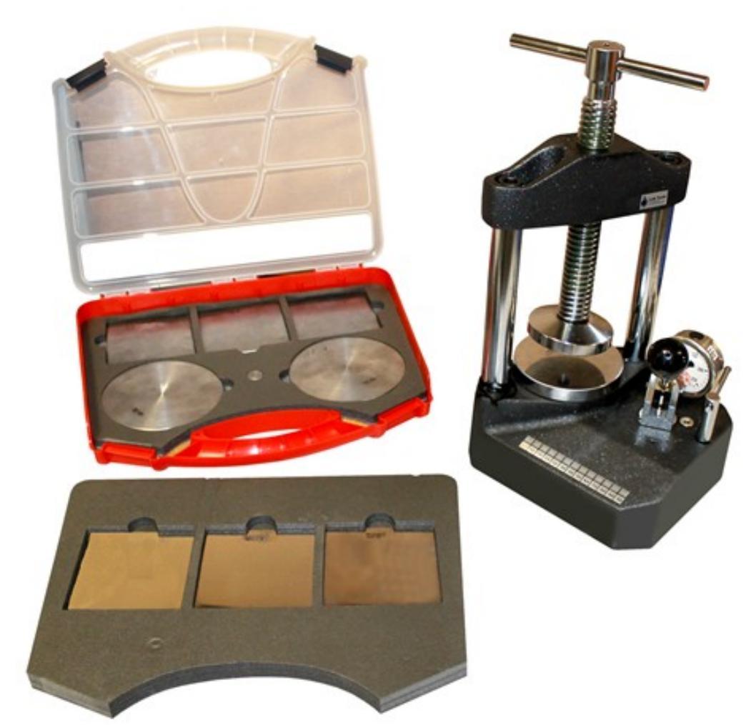
Рисунок 5.5 – Общий вид комплекта учебно-лабораторного оборудования «Исследование влияния холодной пластической деформации и последующего нагрева на микроструктуру и твердость низкоуглеродистой стали».
