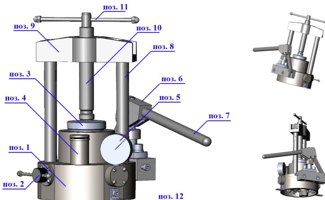
Рисунок 5.6 – Устройство прессы: 1 – корпус; 2 – выпускной винт; 3 – пята; 4 – бак; 5 – манометр; 6 – ручной насос; 7 – ручка насоса; 8 – колонны; 9 – переключатель; 10 – прижимной винт; 11 – ручка винта; 12 – кронштейн.
