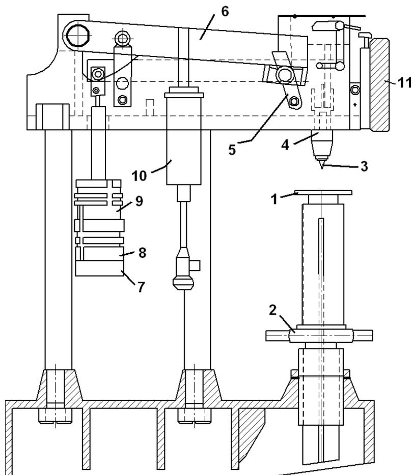
Рисунок 4.4 – Стационарный твердомер по Роквеллу: 1 – верхняя крышка; 2 – задняя крышка; 3 – шкала; 4 – ручка приложения нагрузки; 5 – винт
