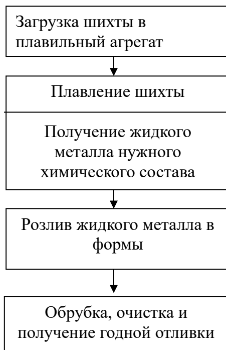
Рисунок 1 – Схема технологического процесса получения отливок
