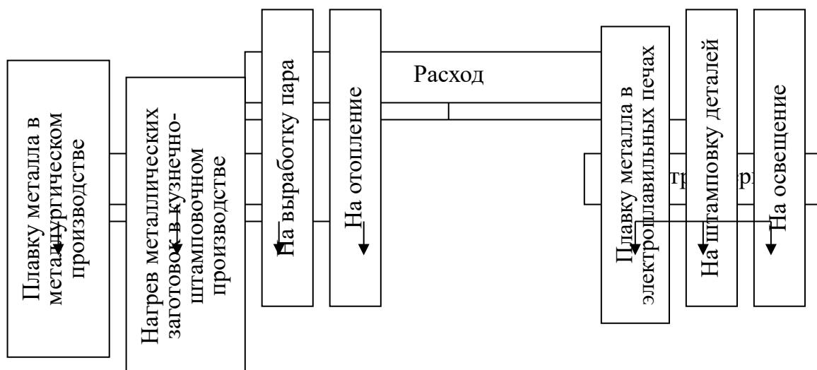
Рисунок 5 – Направления расхода топлива и электроэнергии
