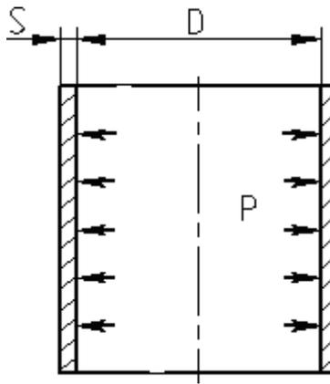
Рисунок 6.1 – Схема к расчету толщины стенки корпуса сосуда Допускаемое напряжение в рабочем состоянии определяется по формуле:
