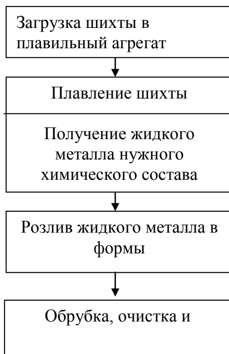
Рисунок 1 – Схема технологического процесса получения отливок
