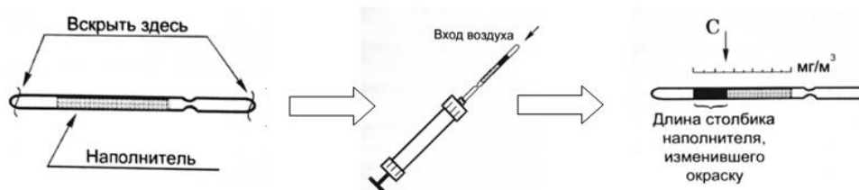
Рисунок 32. Схема определения концентрации диоксида углерода с помощью индикаторных трубок
