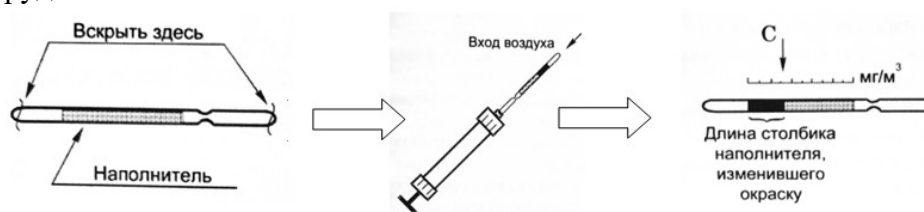
Рисунок 31. Схема определения концентрации диоксида углерода с помощью индикаторных трубок
