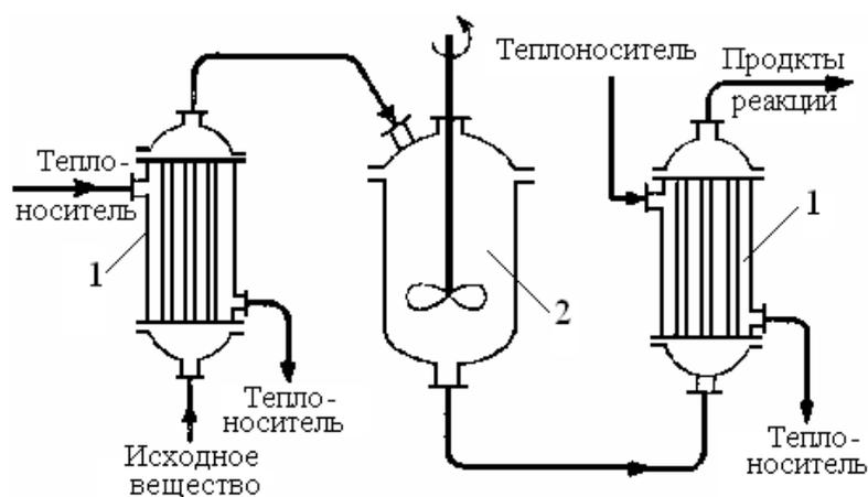
Рисунок. 2 – Реактор смещения, работающий в непрерывном режиме:
