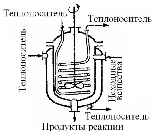
Рисунок. 1 – Реактор смешения, работающий в периодическом режиме
