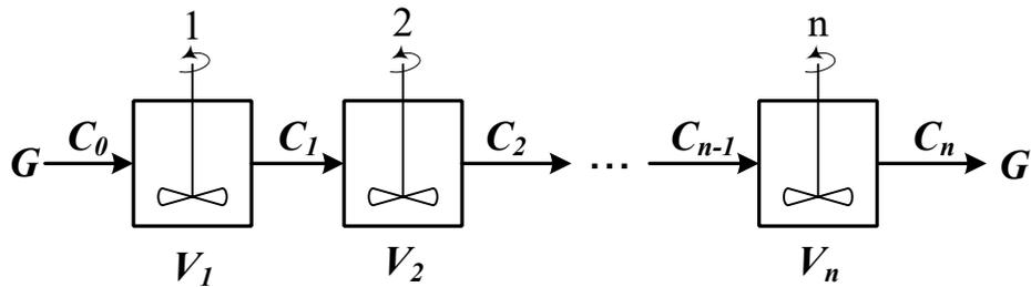
Рисунок 4.5 – Схема аппарата, описываемого ячеечной моделью
