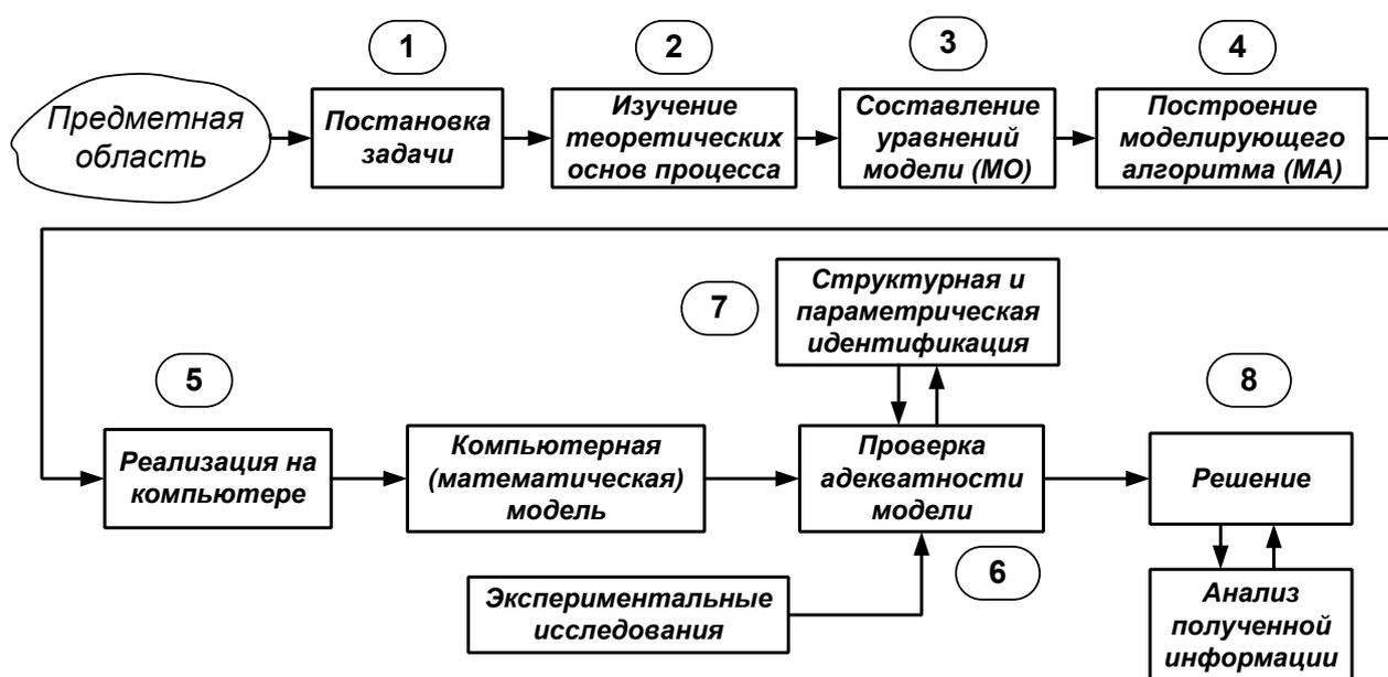
Рисунок 1 – Общая схема процесса математического моделирования
