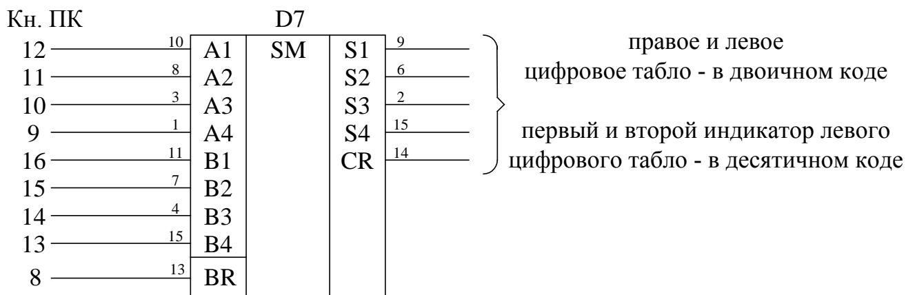
Рисунок 7.4 – Функциональная схема установки для исследования цифрового сумматора
