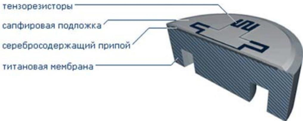
Достоинствами технологии являются: высокая чувствительность и стабильность, а также возможность измерения агрессивных сред, нейтральных к сплавам титана. Дополнительную устойчивость к агрессивным средам обеспечивает применение в датчиках безрезинового уплотнения сенсора со штуцером методом посадки «конус по кромке». К недостаткам можно отнести наличие повышенного гистерезиса.
