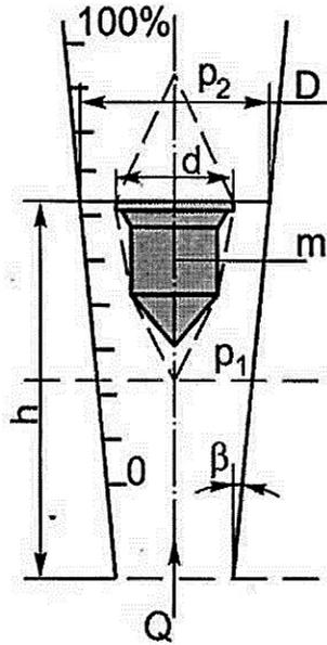
Рис. 6.3. Схема ротаметра
