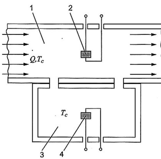
Рис. 6.5. Термоанемометр
