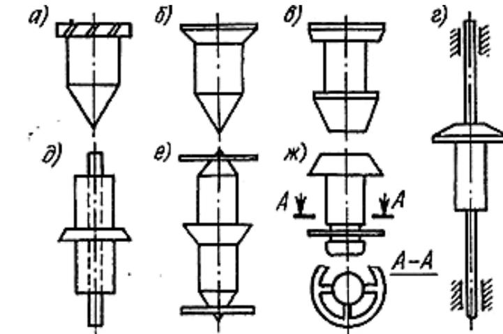
Рис. 6.2. Формы поплавков
