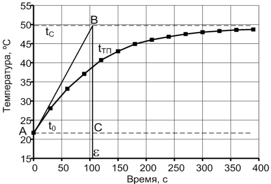
Рис. 3.5. Изменение температуры теплоприемника во времени (кривая разгона)
