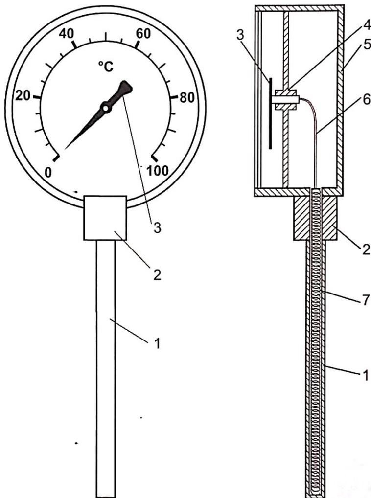
Рис. 2.4. Биметаллический термометр
