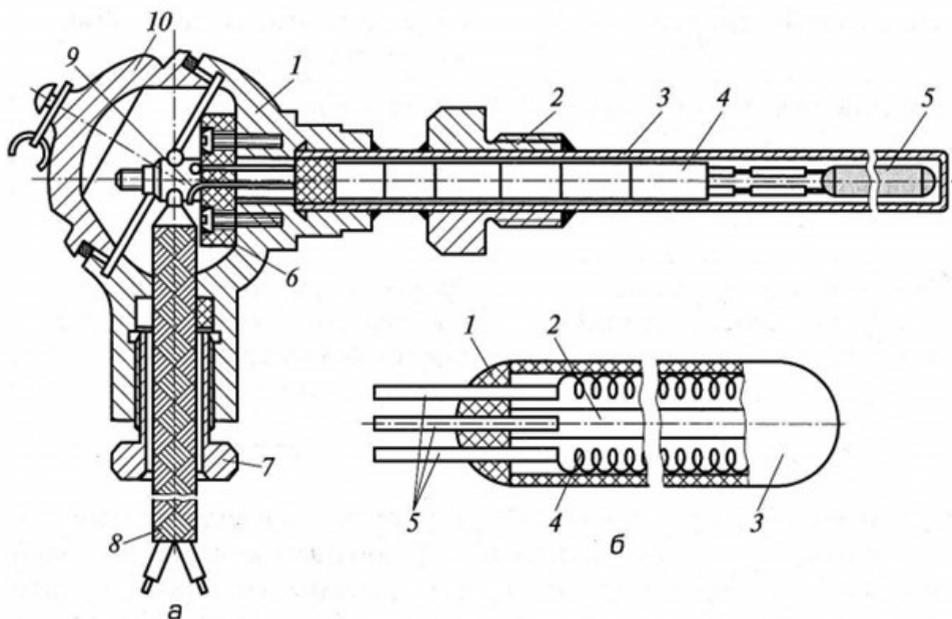
Рис. 2.6. Термометр сопротивления
