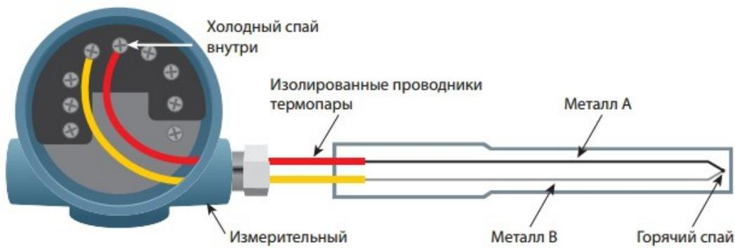
Рисунок 2.5. Термопара
