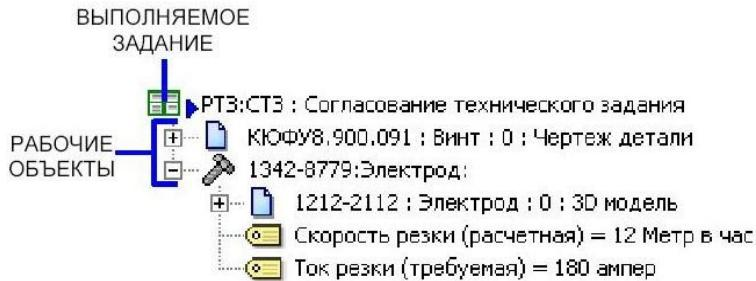
Рисунок 48. Отображение рабочих объектов задания в дереве
