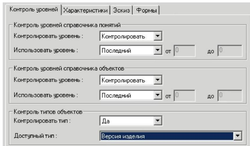
Рис. 13 - Вкладка «Контроль уровней» диалогового окна создания справочника
