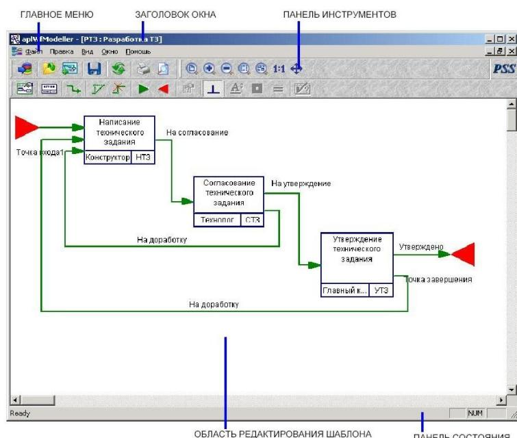
Рисунок 1. Главное окно модуля «Редактор шаблонов процессов»
