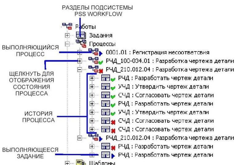
Рисунок 19. Отображение процессов, их историй и состояний
