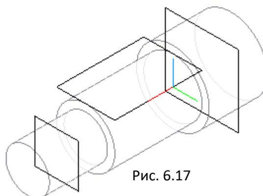
**плоскость** (рис. 6.17). Смещенные плоскости должны быть параллельны координатной плоскости **XZ**.
