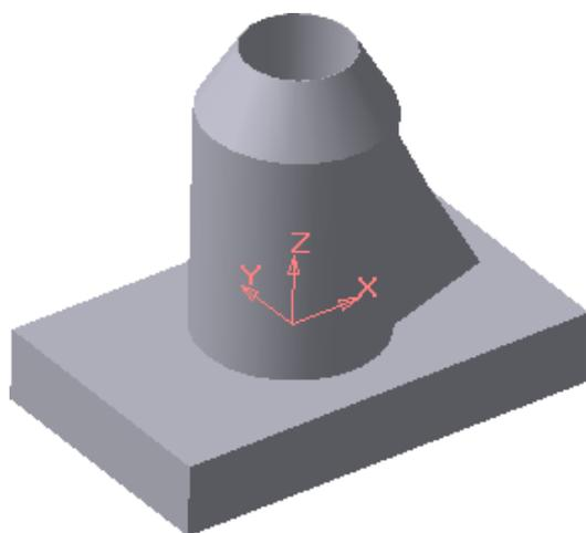
Рис. 7.2. Модель с выполненной фаской на цилиндре
