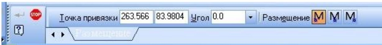
Рис. 3.16. **Панель свойств** для указания размещения надписи на чертеже (рис. 3.16). Указав графическим курсором на рабочем поле положение начальной точки текста, фиксируем его нажатием левой клавиши мыши.
