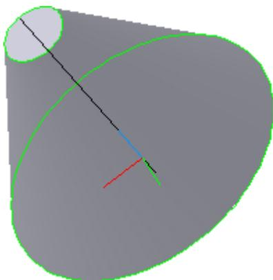
Рис. 6.2. Вспомогательная ось через ось вращения конической поверхности вращения
