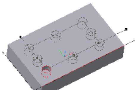
Рис. 7.14. Фантом массива отверстий в прямоугольной сетке
