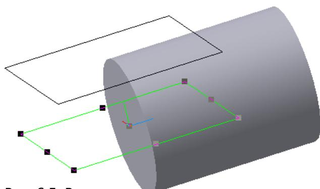
Рис. 6.5. Вспомогательная плоскость, смещенная относительно координатной плоскости **XOZ**
