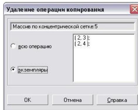
Рис. 7.20. Окно диалога по удалению части элементов массива
