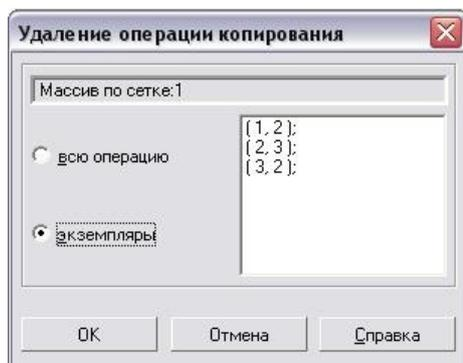
Рис. 7.15. Окно диалога по удалению части элементов массива
