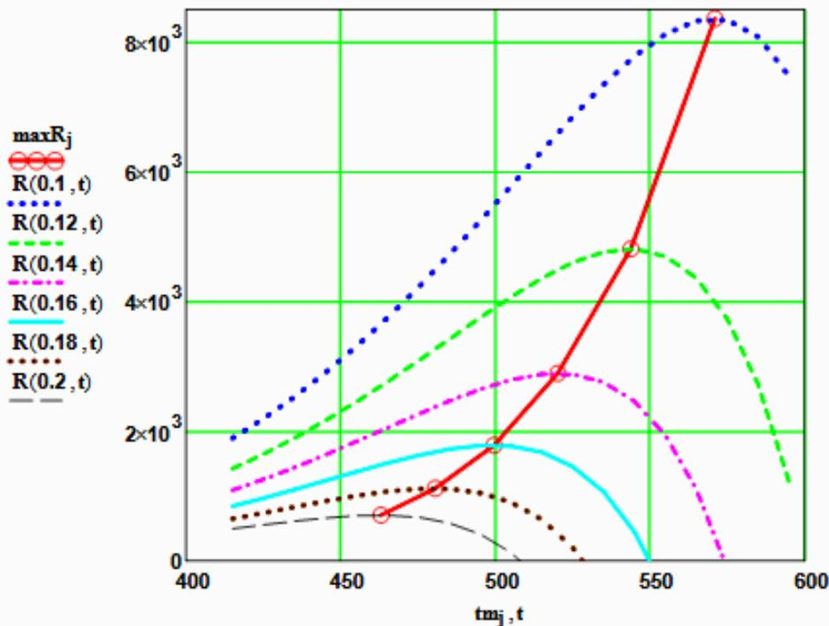
Рисунок 4 – Построение линии оптимальных температур (ЛОТ)
