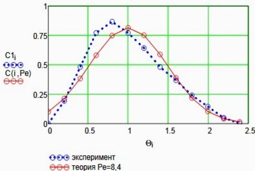
**Рисунок 3 – Экспериментальная и теоретическая функции распределения времени пребывания**
