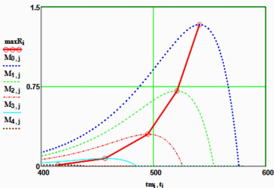
Рисунок 4 – Построение линии оптимальных температур (ЛОТ)
