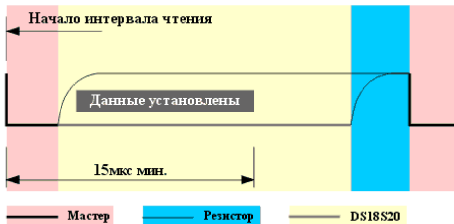
Рис. 7.8. Чтение бита по 1-проводной шине
