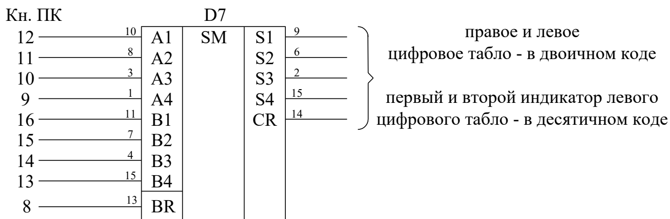
Рисунок 7.4 – Функциональная схема установки для исследования цифрового сумматора
